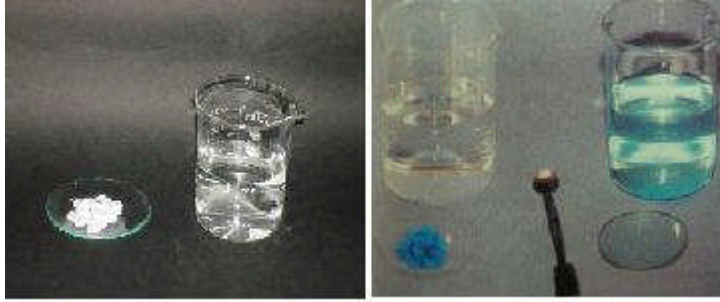
Resim 1.9: Katı çözünen maddenin beherde çözündürülmesi
