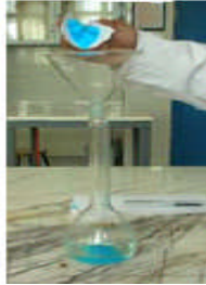
Resim 2.3: Çözünen maddenin balon jojeye aktarılması
