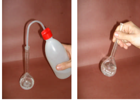
Resim 2.4: Çözünen maddenin balon jodede çözündürülmesi
