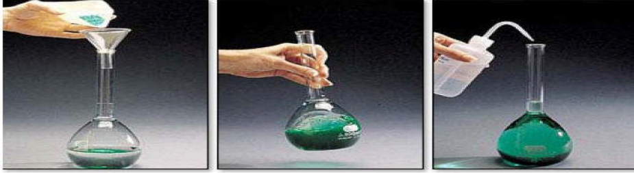
Resim 2.1: Molar çözelti hazırlama aşamaları
