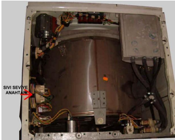
Resim 1.7: Makine iç görünüşü (su seviye anahtarı)
