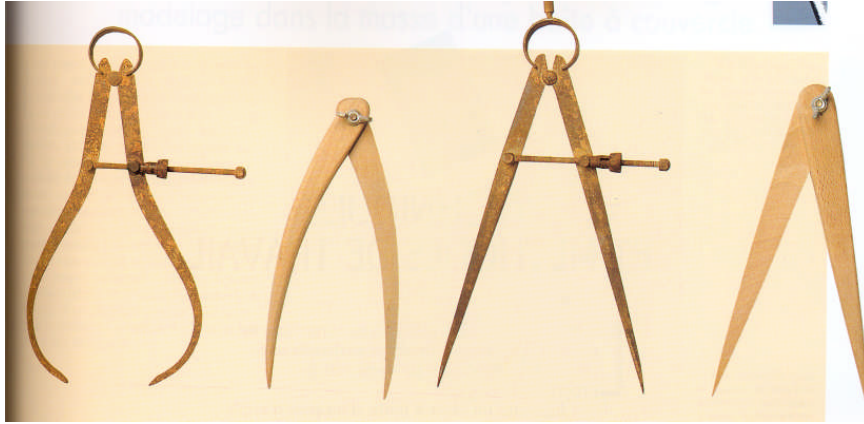
Resim 3.8: İç çap, dış çap kumpasları
