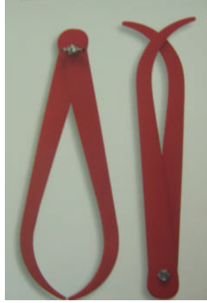
Resim 3.7: İç çap, dış çap kumpasları
