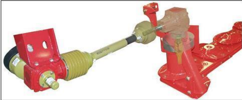
Resim 4.2: Ara Őaft yardımıyla hareket iletimi
