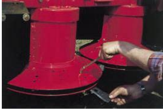
Resim 3.15: Bıçakların özel aparat yardımı ile değiştirilmesi
