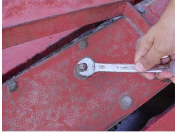
Resim 3.14: Tambur hareket mili yağ kontrolü
