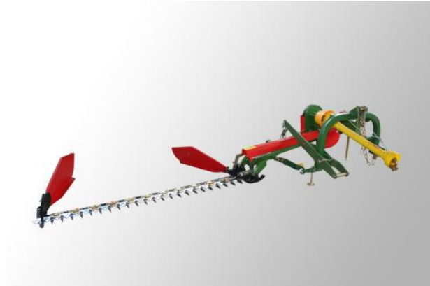
Resim 1.14: Yataylığı düzgün ayarlanmış bir parmaklı çayır biçme makinesi
