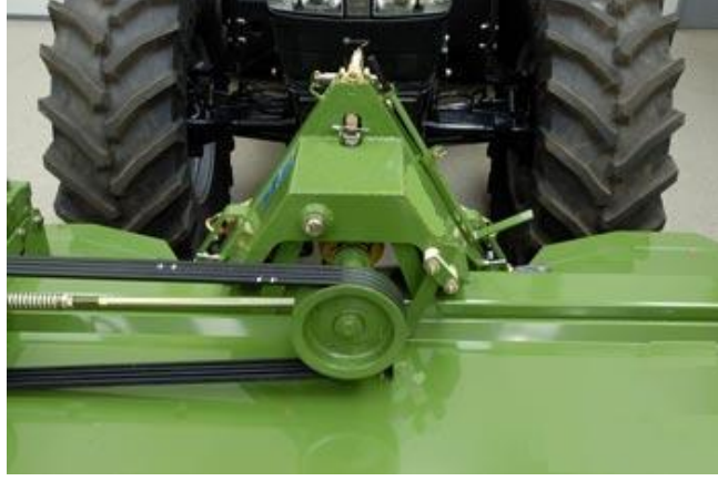
Resim 4.3: Kayış kasnak sistemiyle hareket iletimi
