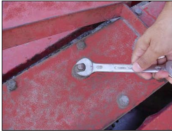
Resim 3.3: Tambur hareket mili yağ kontrolü
