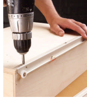
Resim 2.12: Çekmece rayının çekmeceye montajı
