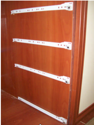
Resim 2.22: Çoklu çekmecelerin gövdeye montajı
