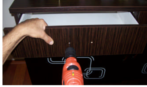
Resim 2.14: Kulp ve sap deliklerinin delinmesi
