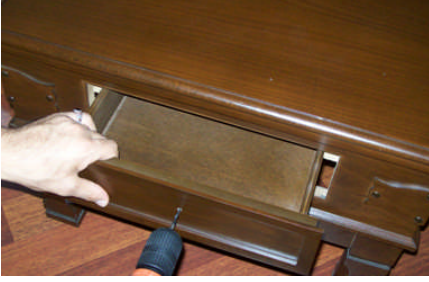
Resim 2.14: Kulp ve sap deliklerinin delinmesi
