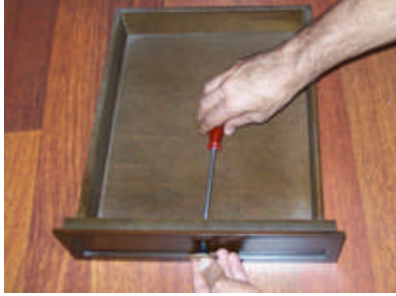
Resim 2.15: Kulp ve sapların çekmeceye montajı
