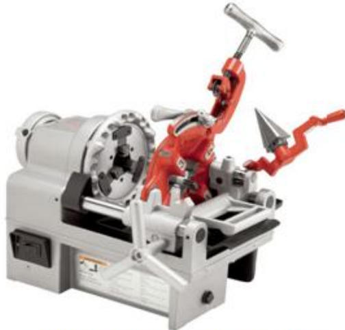
Resim 2.1: Elektrikli boru pafta tezgâhı
