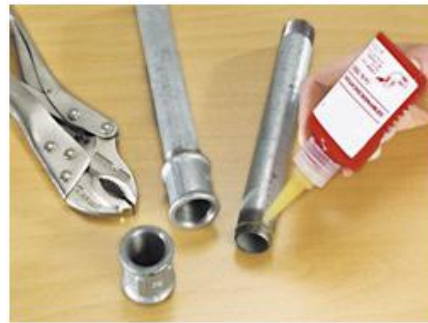
Resim 3.13: Sıvı conta sürülmesi
