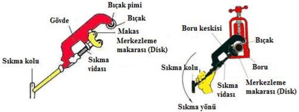
Şekil 1.18: Metal boru keski kısımları ve kesme yönü
