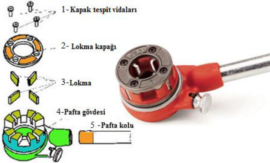
Şekil 2.2: Sabit lokmalı cırcırlı boru paftası
