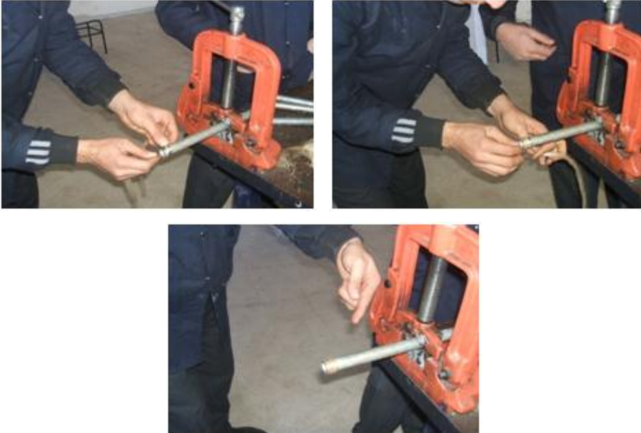
Resim 3.10: Diş açılmış boruya keten sarma
