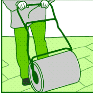
Resim 4.8: Serme işleminden sonra silindir çekilmesi
