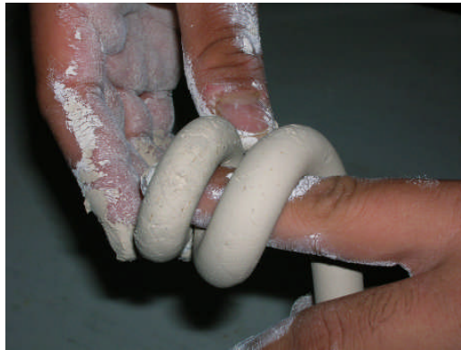
Resim 1.8: Çamur kıvam kontrolleri (Sert kıvamlı çamur görüntüsü)
