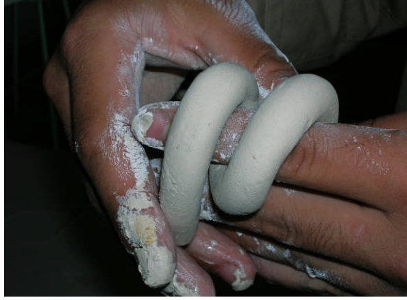
Resim1.9: Çamur kıvam kontrolleri (Plastik kıvamdaki çamur görüntüsü)
