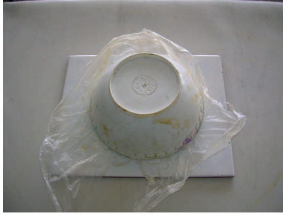
Resim 3.14: Kalıbın düz bir zemine ters çevrilmesi
