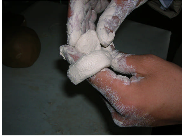
Resim1.10: Çamur kıvam kontrolleri (Yumuşak kıvamlı çamur görüntüsü)
