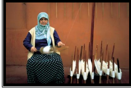
Resim 1.41: Kurutulan iplikler çile haline getirilmesi:
