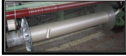
Resim2.18: Demir levente sarılması
