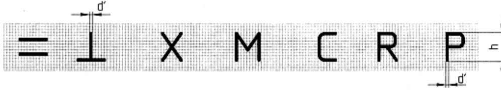
Şekil 2.31: İşleme İzleri Sembol ve Boyutları
