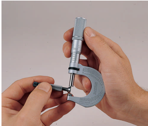
Resim 2.6: Mikrometre ile ölçme
