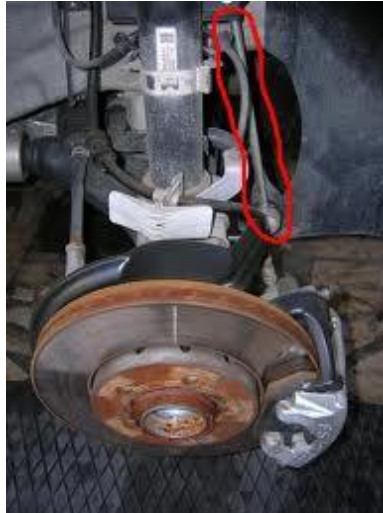
Resim 7.6: Viraj denge çubuğu sistemdeki yeri
