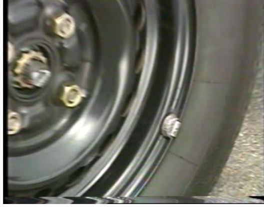
Resim 1.20: Janta akılan balans aęırlıęı
