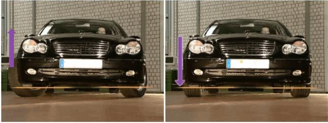
Resim 8.2: King-pim açısı direksiyon toplama etkisi
