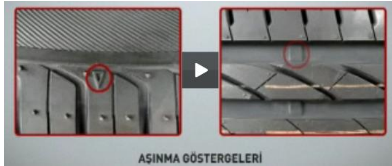
Resim 1.10: Lastik üzerinde bulunan aşınma göstergeleri
