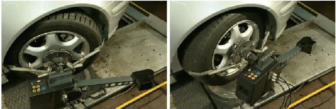
Resim 8.4: Ön düzen cihazının başlıklarının tekerleklere takılması
