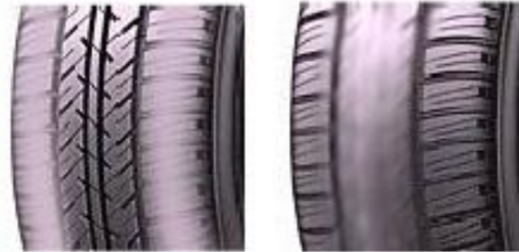
Resim 1.11: Lastiklerin hatalı şişirmeleri sonucu lastikte meydana gelen aşınma
