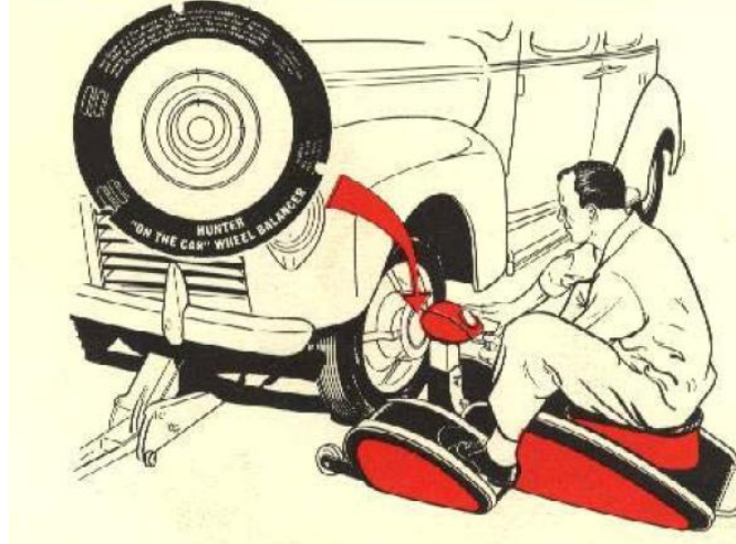
Şekil 1.35: Seyyar balans cihazı ile balans ayarı
