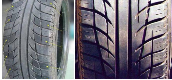
Resim 1.15: Aks yataklarındaki boşluk sonucu oluşan aşınmalar
