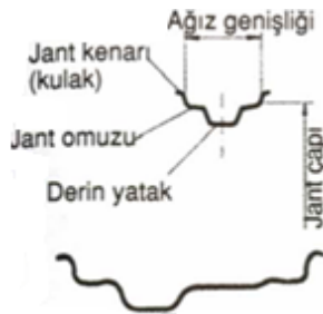
Şekil 1.7: Derin yataklı jantlar
