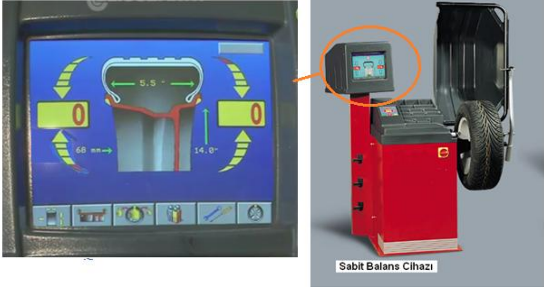
Resim 1.21: Sabit balans cihazı ile balans
