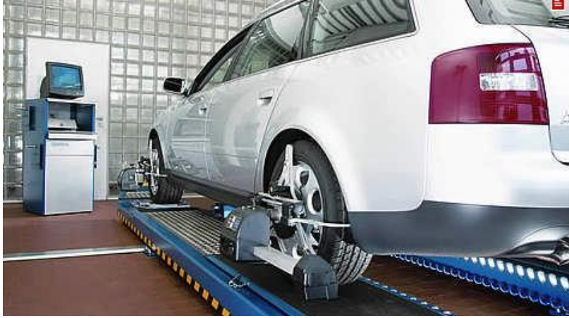
Resim 8.3: Ön düzen ayar cihazına bağlanmış bir araç
