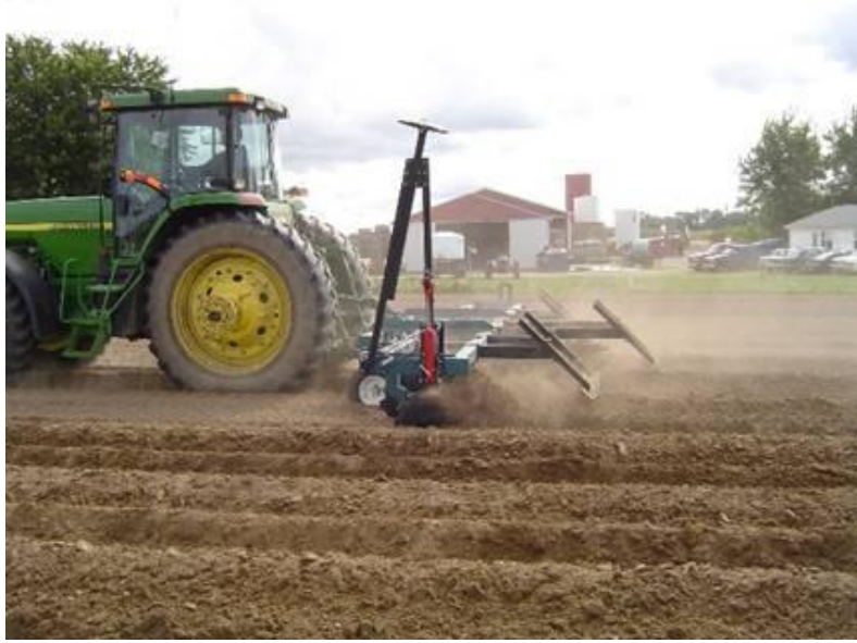
Resim 1.1: Malç plastik sermeden önce karık ve karık sırtlarının hazırlığı
