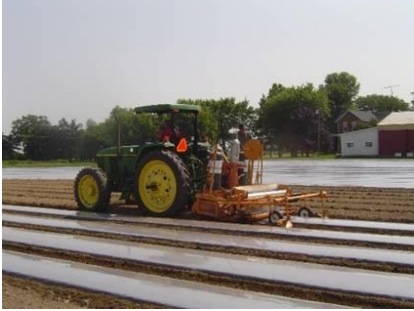
Resim 1.3: Malç plastiğın makine ile serilmesi
