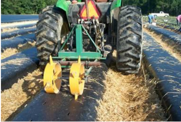
Resim 1.4: Malç plastiğın makine ile delinmesi
