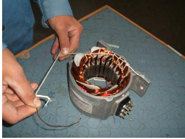
Resim 2.9: Stator bandajının yapılması
