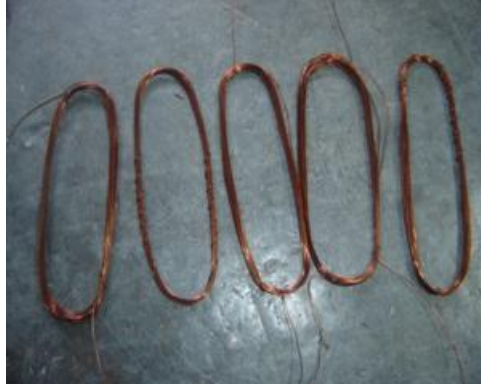
Resim 2.5: Sarım için hazırlanan bobinler
