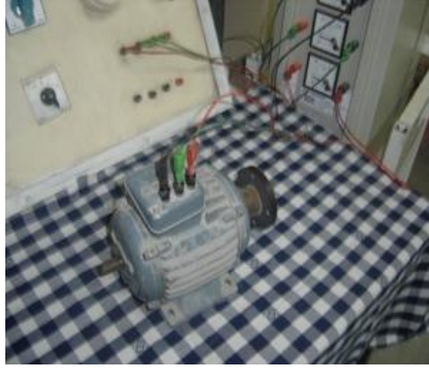
Resim 2.1: Motorun arıza kontrolleri
