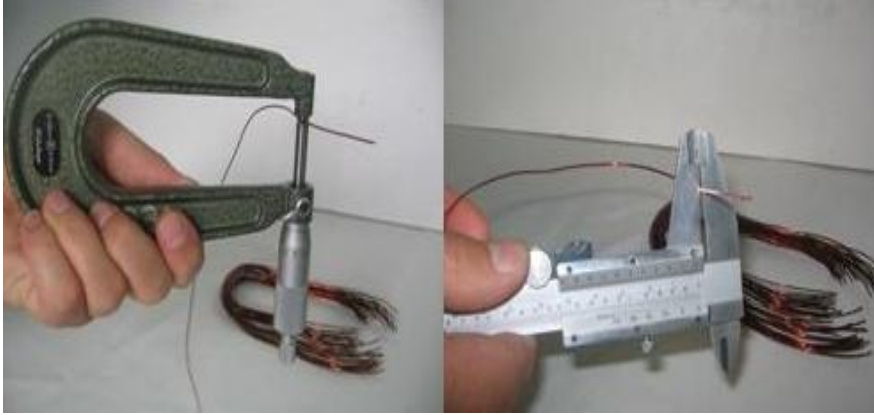
Resim 1.1: Tel çapının ölçülmesi
