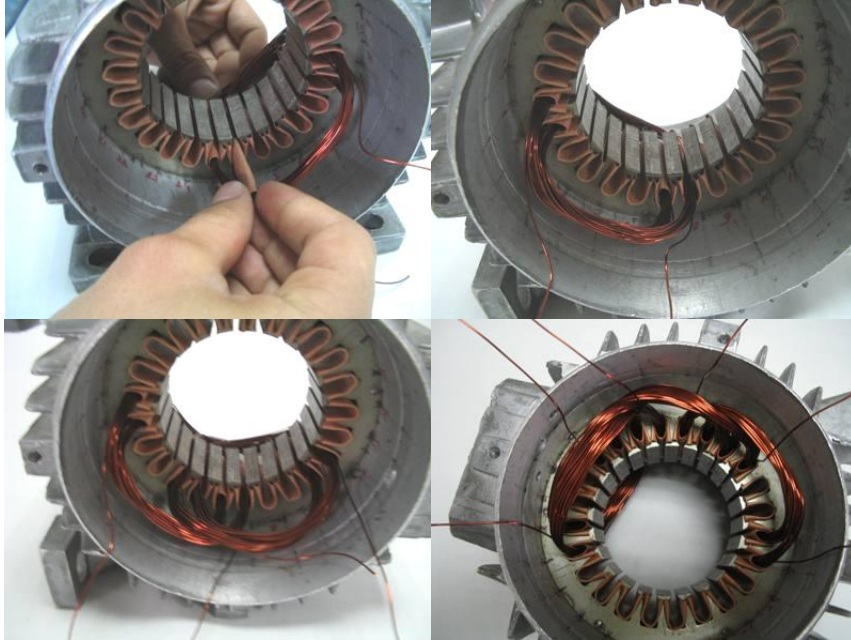
Resim 1.8: Bobinlerin oluklara yerleştirilmesi
