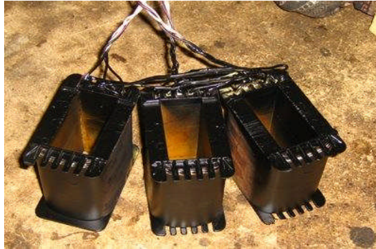
Resim 3.7: 3 adet sarımı ve yalıtımı tamamlanmış bobin
