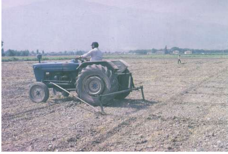
Resim 3.3: İşaretleme ekipmanı ile bağ alanının işaretlenmesi
