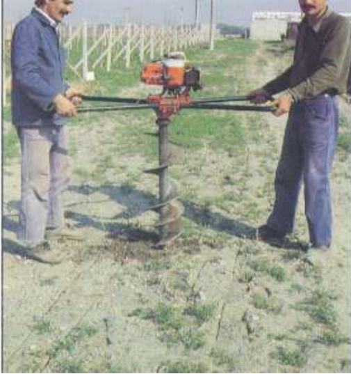
Resim 3.5: Motorlu el burgusu ile dikim çukurlarının açılması
