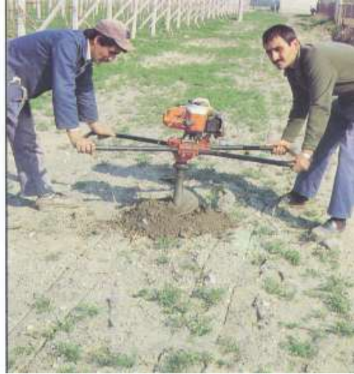
Resim 3.5: Motorlu el burgusu ile dikim çukurlarının açılması
