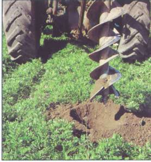
Resim 3.4: Traktör burgusu ile dikim çukurlarının açılması
