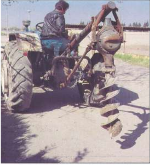
Resim 3.4: Traktör burgusu ile dikim çukurlarının açılması
