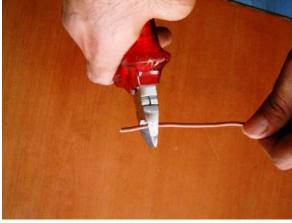
Resim1.38: Kablonun yan keski ile soyulması ve klavuzla tutturulması
