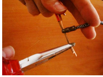
Resim1.38: Kablonun yan keski ile soyulması ve klavuzla tutturulması
