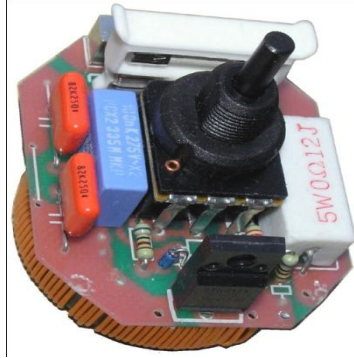
Resim 1.36: Dimmer anahtarın iç yapısı
