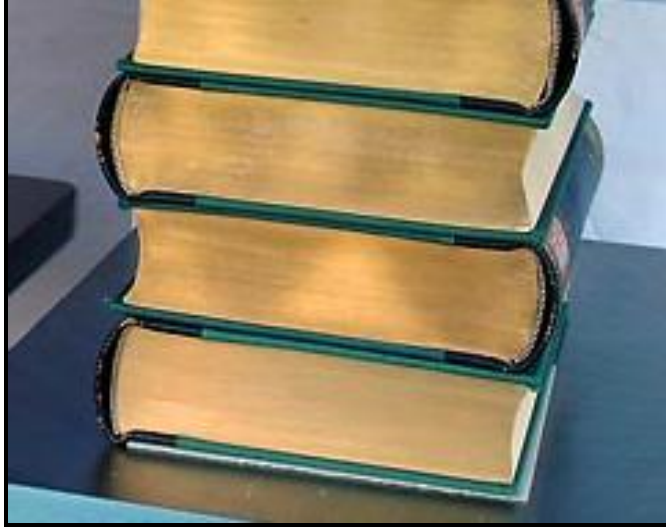
Resim 2 .2: Kambura yapılmış, taslanmış ciltler
