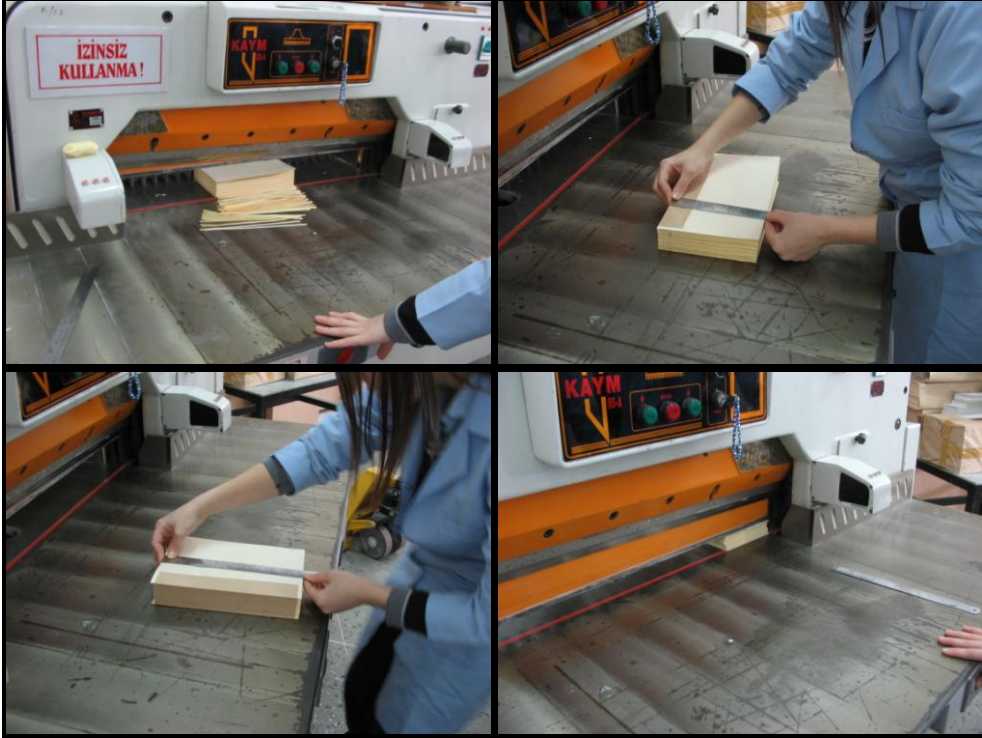
R Resim 1 .5: İç bloğun ölçüye göre kesilme aşamaları
