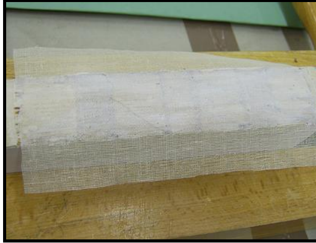
Resim 3 .2 :Sırta tela yapıştırılmış bir cilt bloğu
