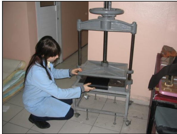
Resim 3 .6: Kollu preste kitabın sıkıştırılması
