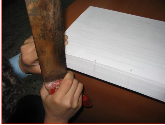
Resim 3.2: Testere ile kâğıt bloğunun 45 derece kesilmesi
