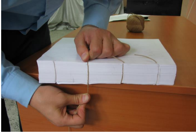
Resim 3.3: Çentik açılmış bir kâğıt bloğuna sicim takılması
