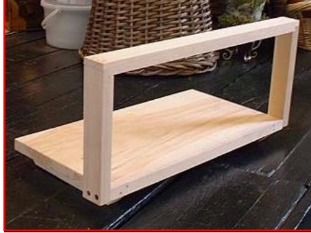
Resim 1.6: Basit çıtalarla çakılmış bir iplik dikiş tezgâhı
