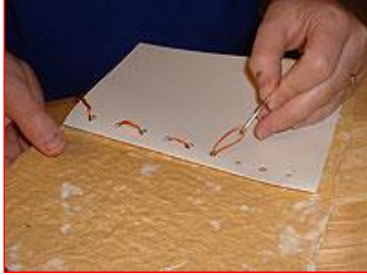
Resim 2.1: Basit bir saplamalı iplik dikiş yapımı
