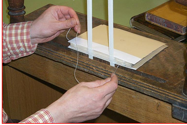
Resim 1.9: İplik dikiş tezgahtında yapılan ekstrafor (bantlı)dikiş yöntemi
