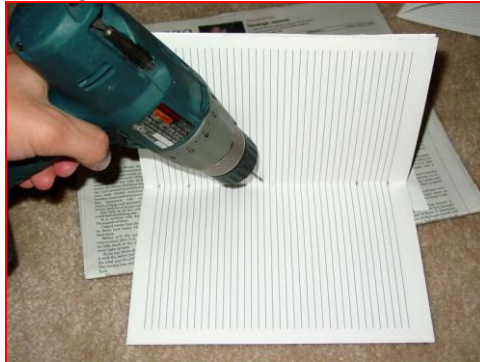
Resim 2.2: El matkabı ile kâğıt bloğunun delinmesi
