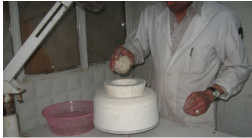
Resim 3.1: Çamurun kalıp üzerine yerleştirilmesi
