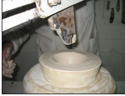
Resim 3.5: Şablondaki çamurun temizlenmesi
