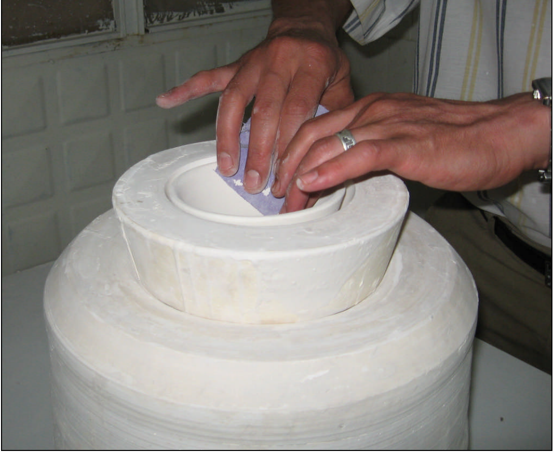
Resim 1.3: 10–15 cm'lik kâsenin iç yüzeyinin zımparalanması
