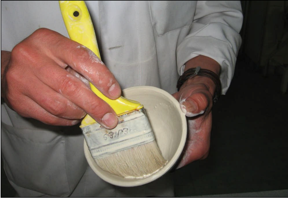
Resim 2.6: Kâsenin iç kısmının astarlanması
