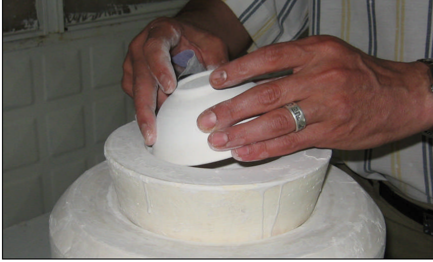
Resim 1.4: Kâsenin bomse üzerinde ters çevrilmesi
