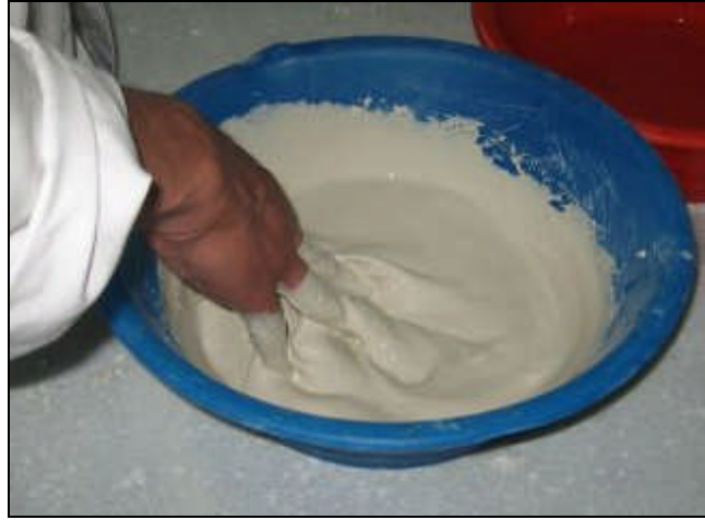
Resim 2. 2: Astarın karıştırılarak hazırlanması
