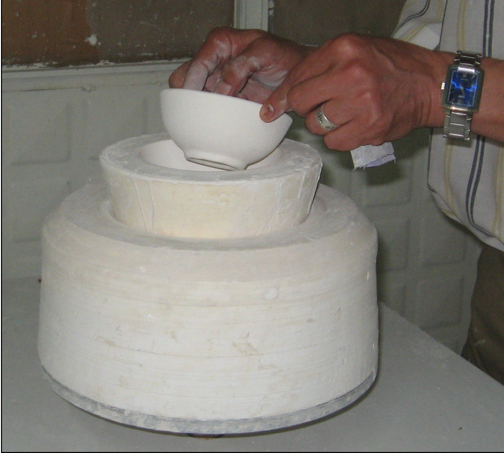
Resim 1.2: 10–15 cm’lik kâsenin bomse merkezine yerleştirilmesi
