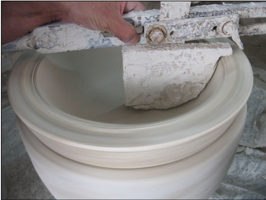
Resim 3.5: Şablon ile perdahlanan kâse yüzeyi.
