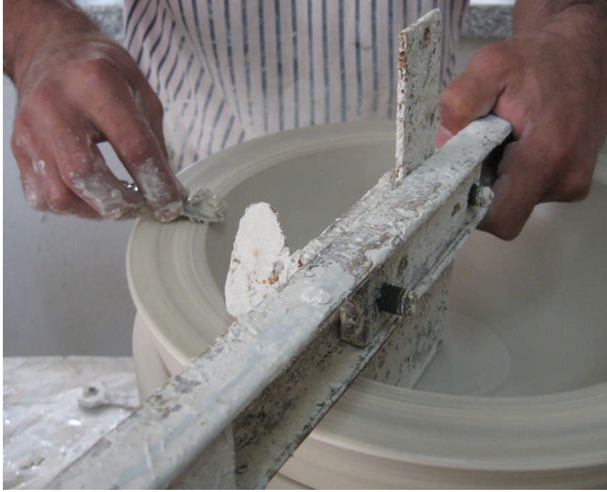
Resim 3.4: Üretim kalıbı üzerindeki çamur fazlalıklarının alınması
