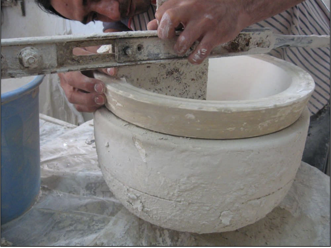
Resim 1.6: Et kalınlığı ayarının yapılması
