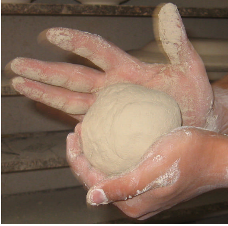
Resim 2.1: Çamurun top hâlinde hazırlanması
