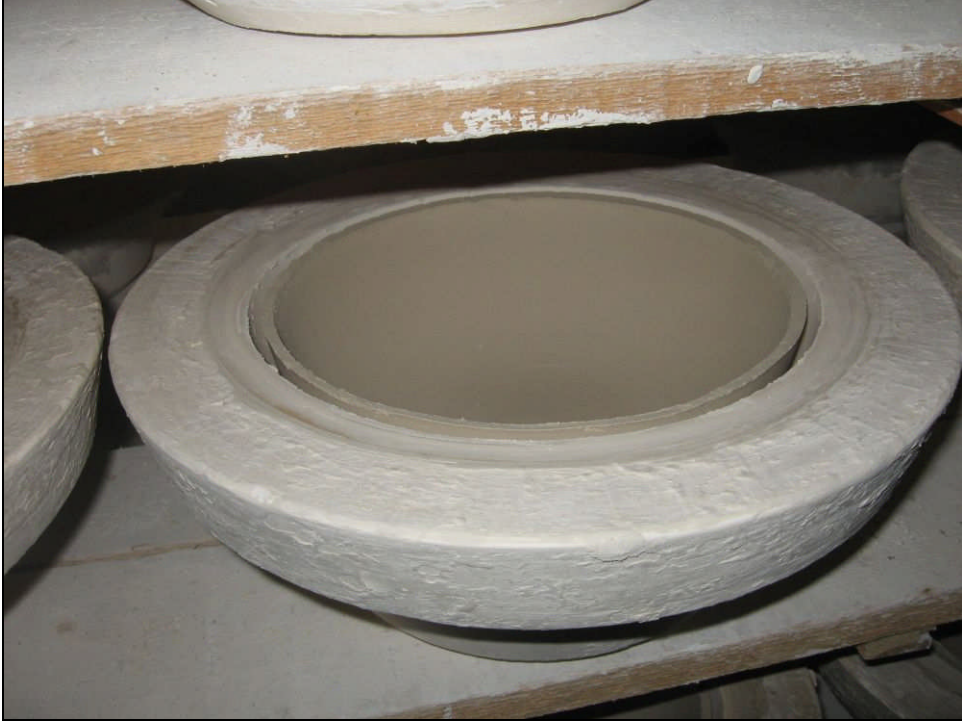
Resim 4.2: Kâsenin kalıp bitim çizgisinden ayrılması
