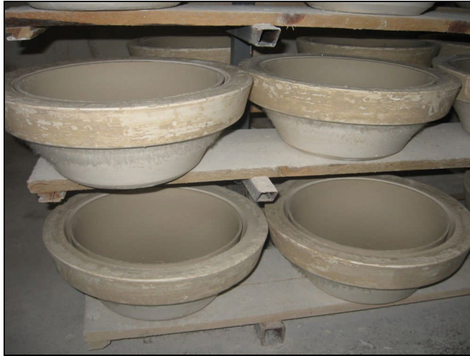
Resim 4.1: Kurutma raflarına dizilen kalıp içerisindeki kâseler
