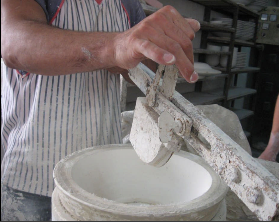
Resim 1.5: Şablonun şablon koluna (konsol) takılması
