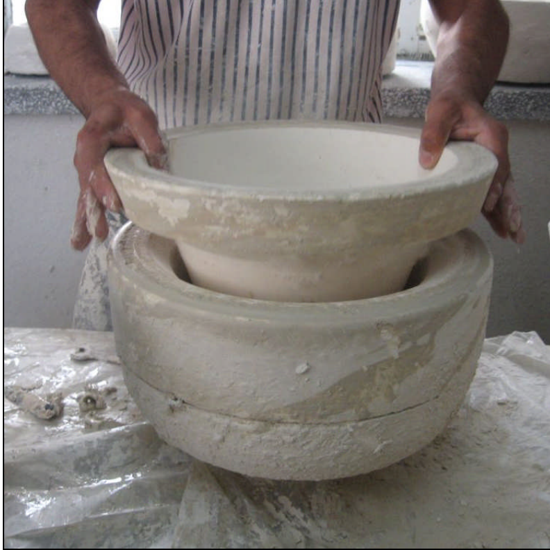
Resim 1.2: Şablon kalıbının şekillendirme başlığındaki yuvasına oturtulması
