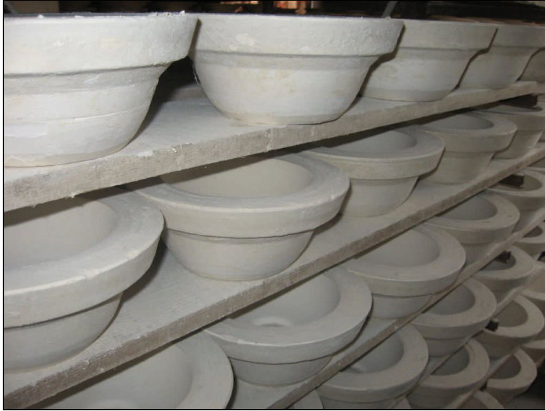
Resim 4.4: Kurutma raflarında bekletilen şablon kalıpları
