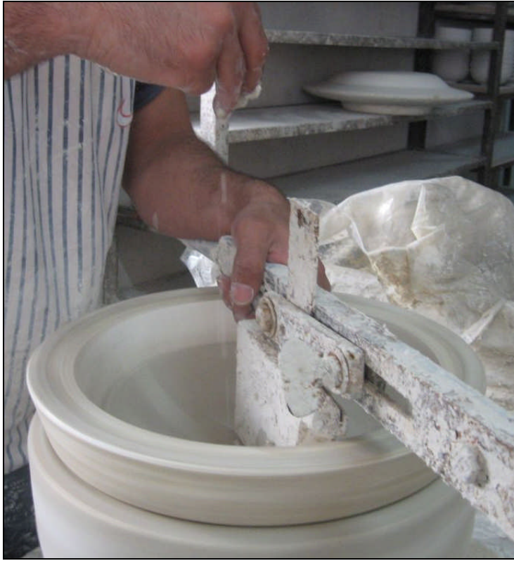
Resim 3.3: Su damlatılan şablon kolunun indirilmesi.
