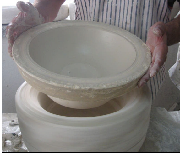
Resim 3.6: Şablon kalıbının şekillendirilme başlığından çıkartılması
