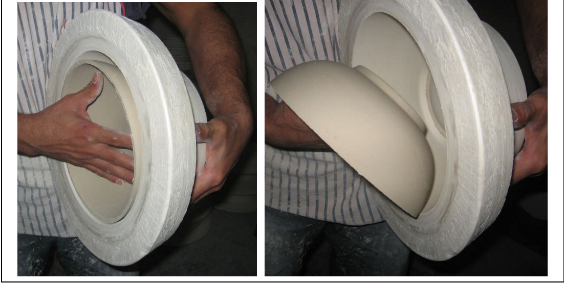
Resim 4.3: Kâsenin kalıptan ayrılması
