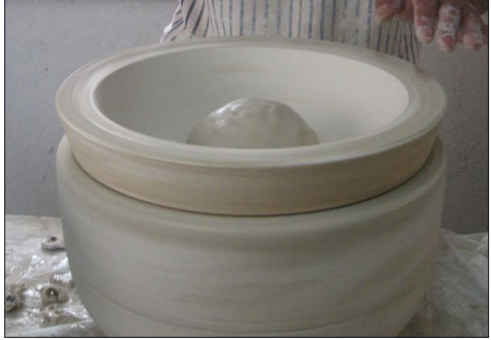
Resim 3.1: Çamurun kalıp üzerine yerleştirilmesi.
