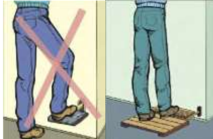
Resim 1.18: Pedal kullanarak yapılan çalışmalarda yanlış ve doğru ergonomik tasarımlar
