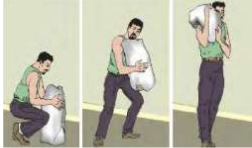
Resim 1.13: Yükün doğru kaldırılması ve indirilmesi
