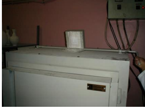
Resim 3.2: Fırın bacasının yakma öncesi açılması
