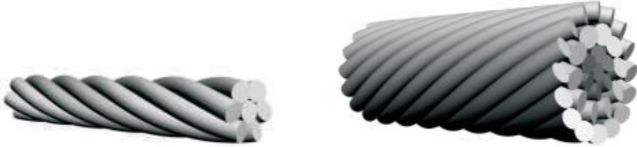
Resim2.3: Alüminyum ve Çelik Özlü Alüminyum İletken
