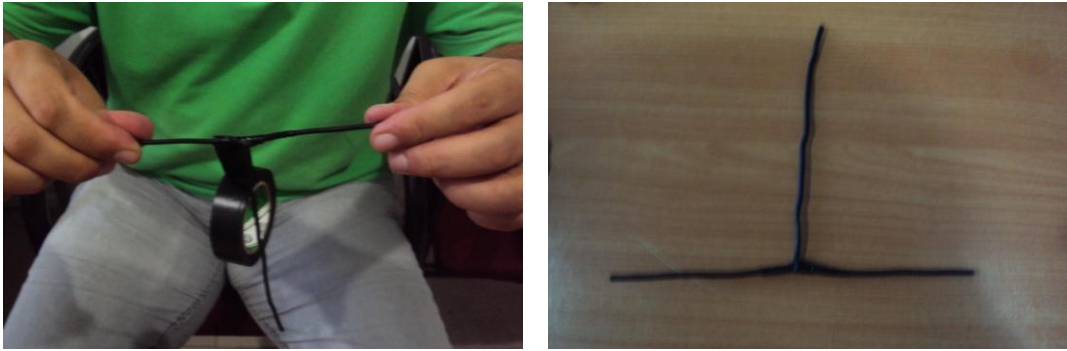
Resim 2.23: T- ek'in üzerine izole bandın sarılması ve bitmiş hâli
