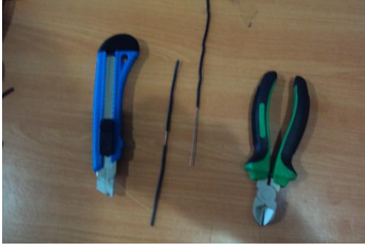
Resim 2.10: İletkenlerin kesilmesi ve soyulması
