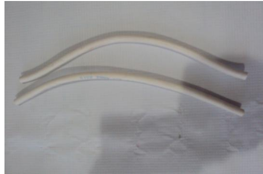
Resim 2.1: İletkenlerin yan keski ile kesilmeleri
