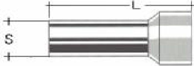
Şekil 4.1: Yüksük üzerinde boy ve kesitin gösterimi
