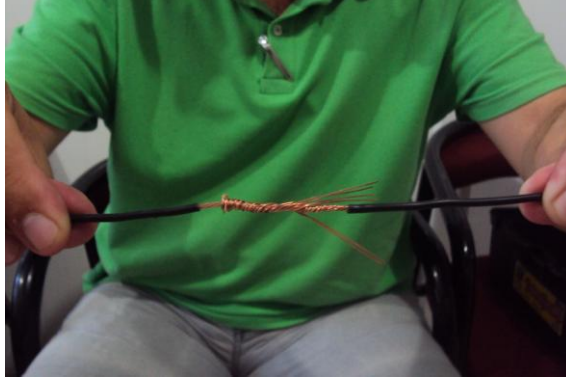
Resim 1.22: Bükme işlemi iletkenlerin birbiri üzerine sarılması
