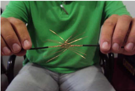
Resim 1.21: İletkenlerin birbiri içine geçirilmesi
