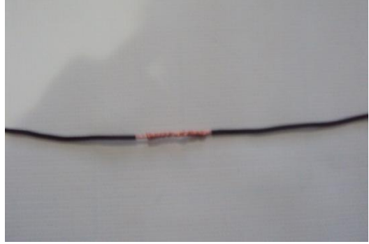
Resim 1.23: Çok damarlı iletkenin düz ek yapılmış hâli
