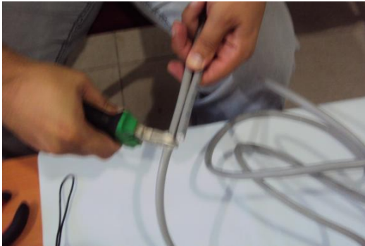
Resim 2.1: İletkenlerin yan keski ile kesilmeleri
