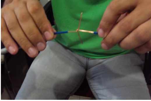
Resim 2.4: Birinci damarın 90°lik açı ile çapraz tutulması ve birbirinin üzerine sarılması
