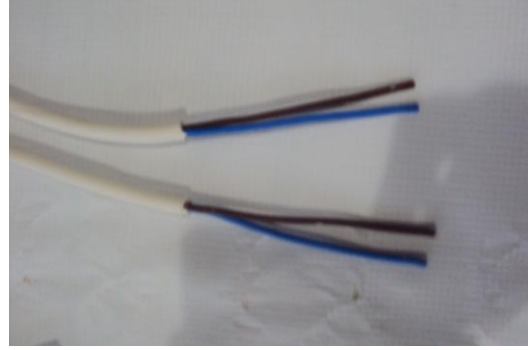
Resim 2.6: Çok damarlı çift iletken kesilmesi
