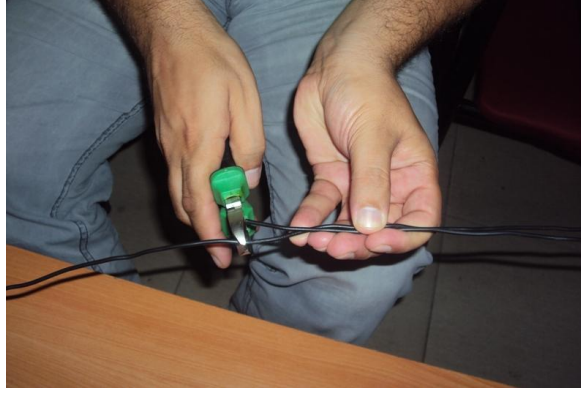
Resim 1.19: İletkenin yan keski ile kesilmesi
