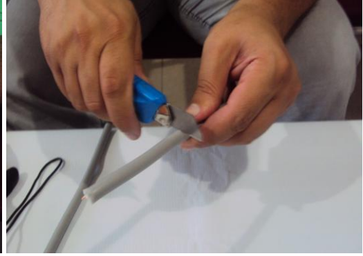
Yan keski ve maket bıçağı ile soyulması
