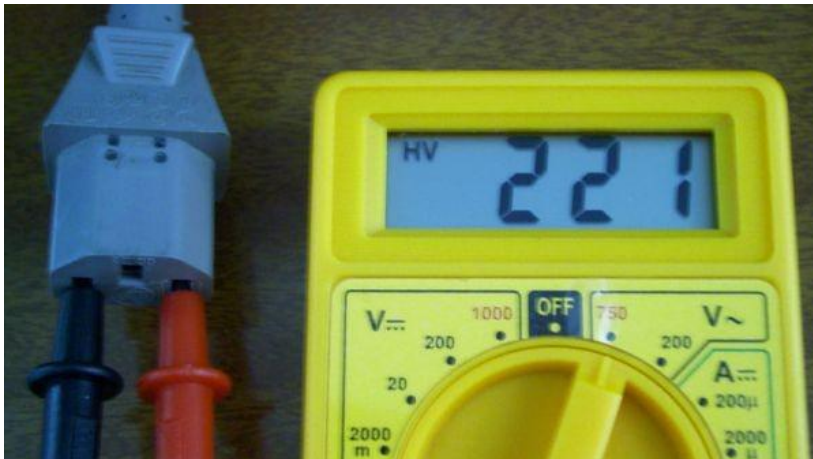
Resim 5.1: Faz nötr arası gerilimin ölçülmesi
