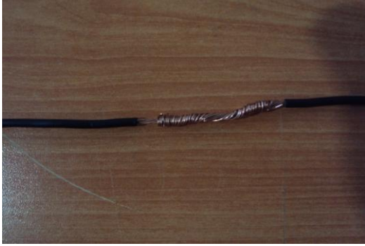
Resim 1.23: Çok damarlı iletkenin düz ek yapılmış hâli
