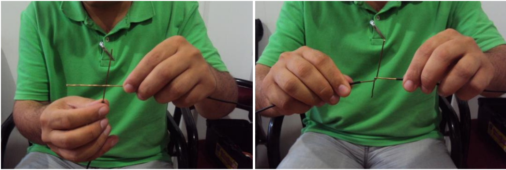
Resim 1.16: İletkenlerin 90° çapraz tutulması
