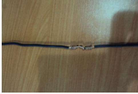
Resim 1.18: Bitmiş tek telli iletkende düz ek
