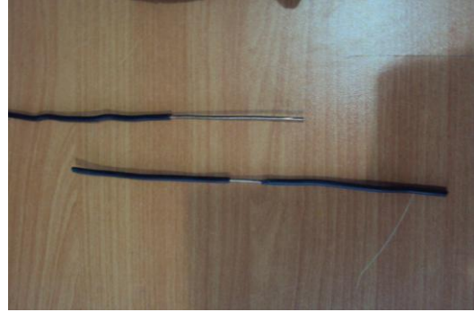
Resim 2.10: İletkenlerin kesilmesi ve soyulması
