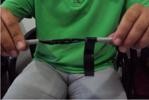
Resim 2.21: Çok telli iletkenlerde çift düz ekin yalıtılması
