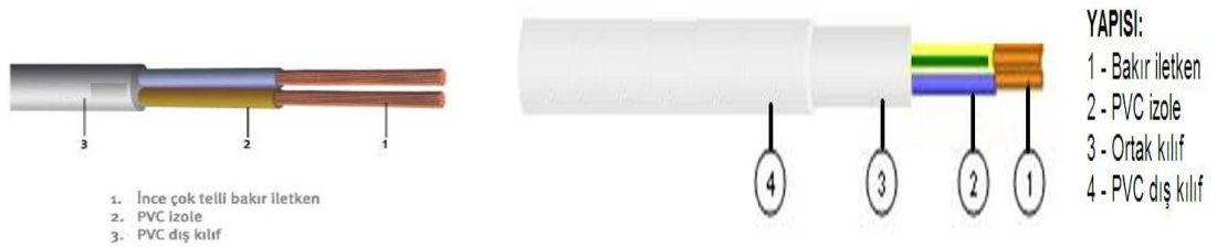
Şekil 2.1: Çift telli tek ve çok damarlı iletkenler ve yapıları
