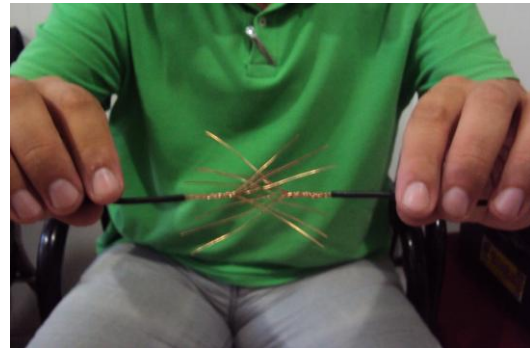
Resim 1.21: İletkenlerin birbiri içine geçirilmesi
