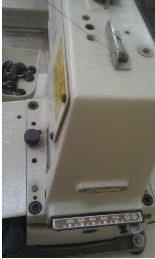
Resim 5.1: Dügme otomatında delik sayısı seçimi
