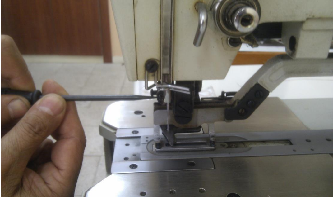
Resim 1.5: İlik otomatına iğne takma işlemi
