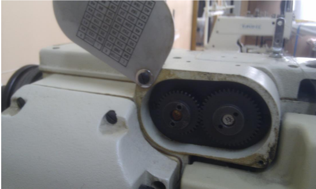
Resim 2.2: İlik otomatında batış sayısını belirleyen dişliler
