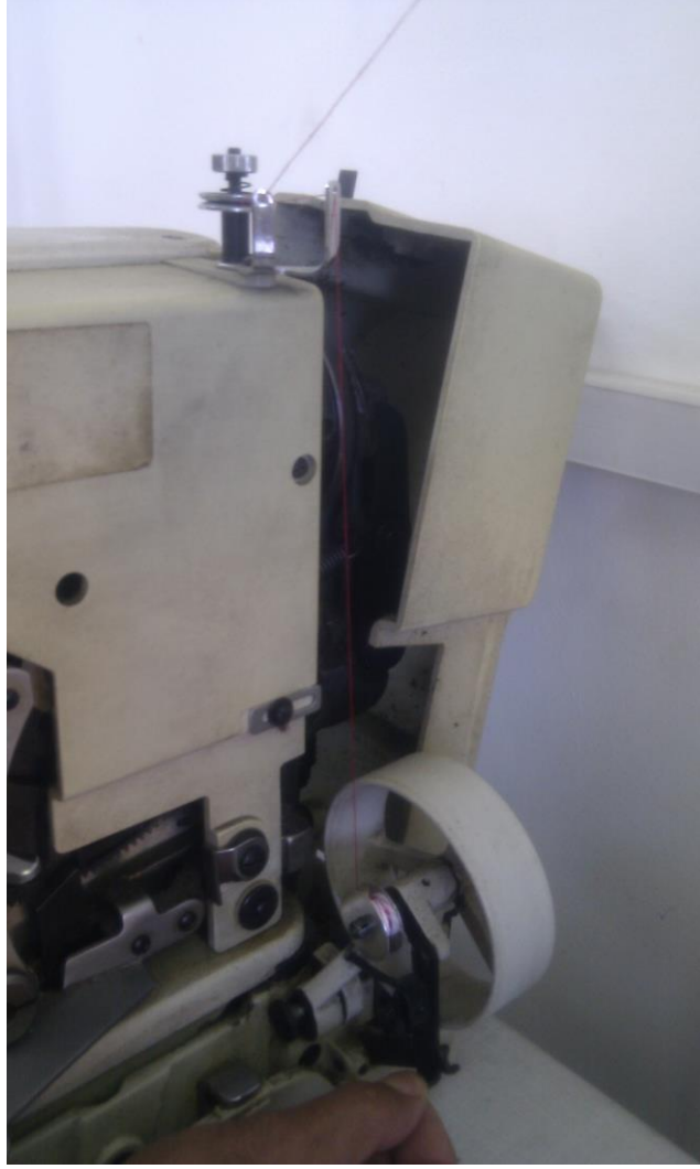
Resim 1.7: Masuralık sisteminde masuraya iplik sarma işlemi
