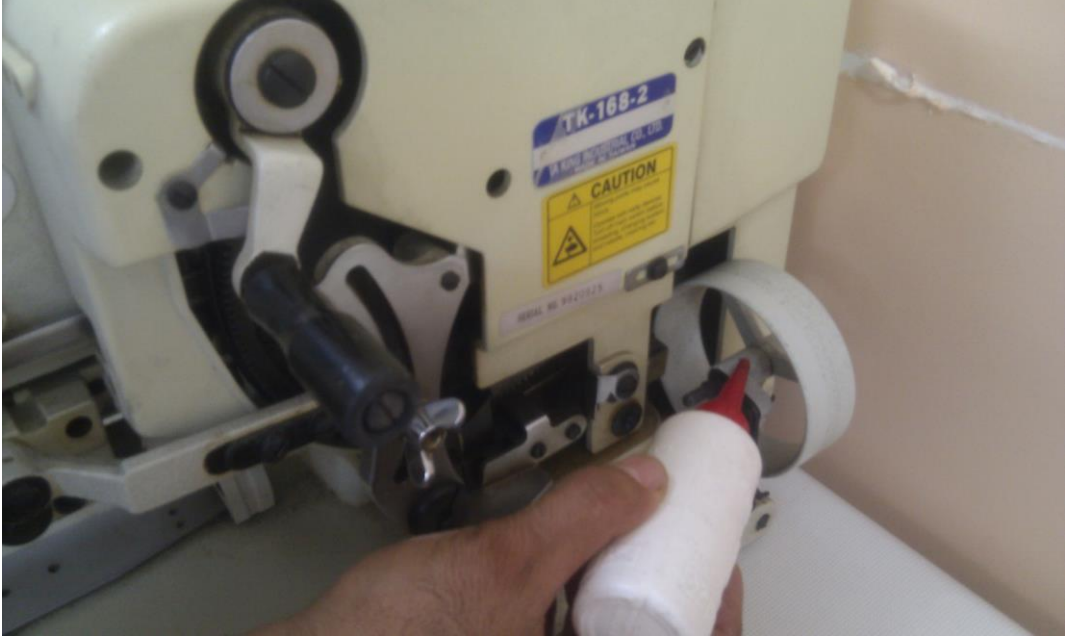
Resim 3.1: İlik otomatında masuralık sisteminin yağlanması
