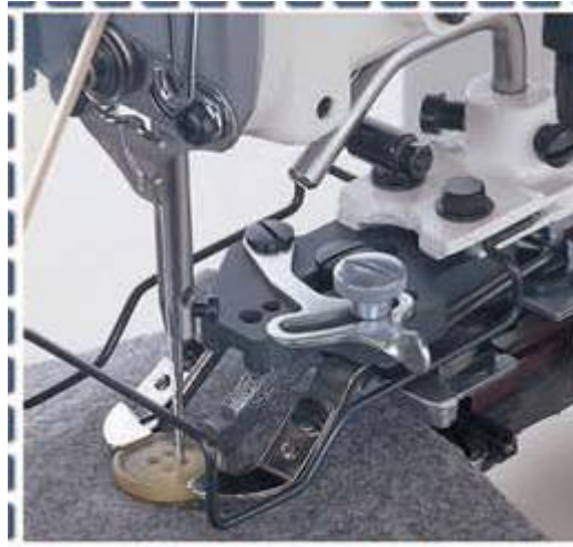
Resim 4.2: Otomatta dört delikli düğme dikimi
