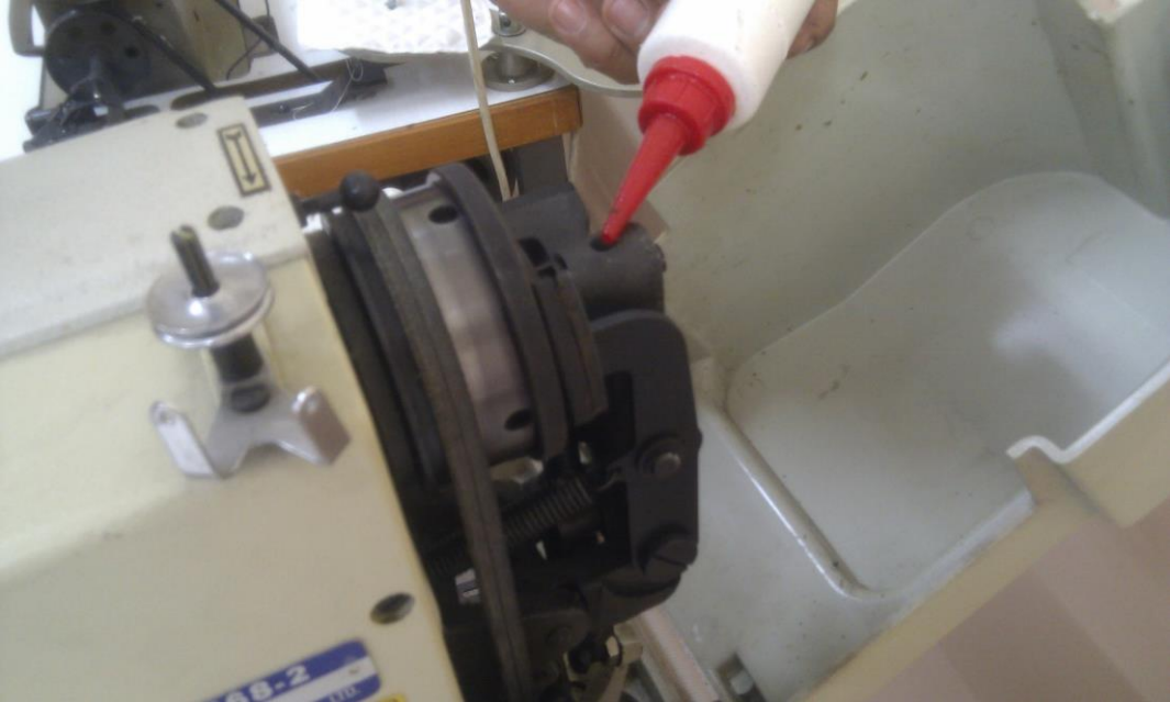
Resim 3.2: İlik otomatında manivelanın yağlanması
