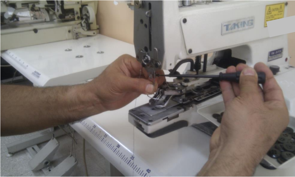
Resim 4.5: Düğme otomatına iğne takma işlemi
