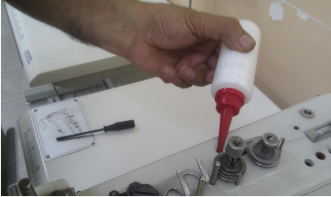
Resim 6.1: Düğme otomatını yağlama işlemi
