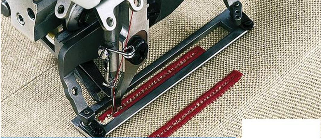
Resim 2.3: İlik otomatı çalışması
