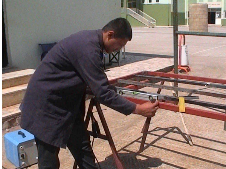
Resim 2.3: Su terazisi ile serbest zeminde kontrol
