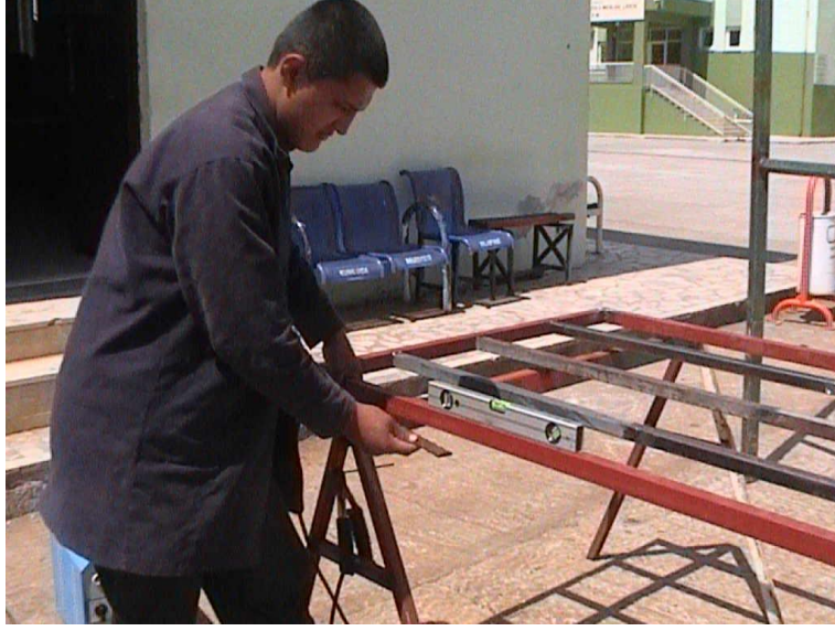
Resim 2.4: Su terazisi ile montaj zeminini teraziye alma
