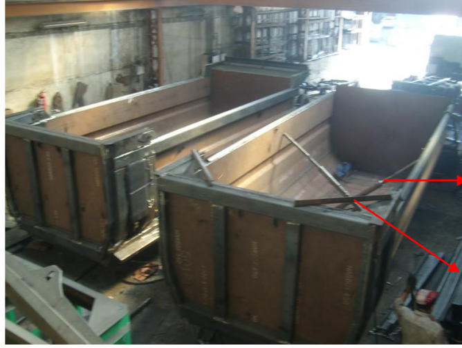
Resim1.6: Çarpımlara karşı önlem alınarak yapılan damper
