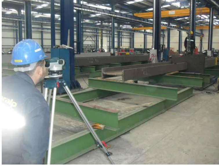
Resim 2.8: Optik ölçme ile gönyeye alma
