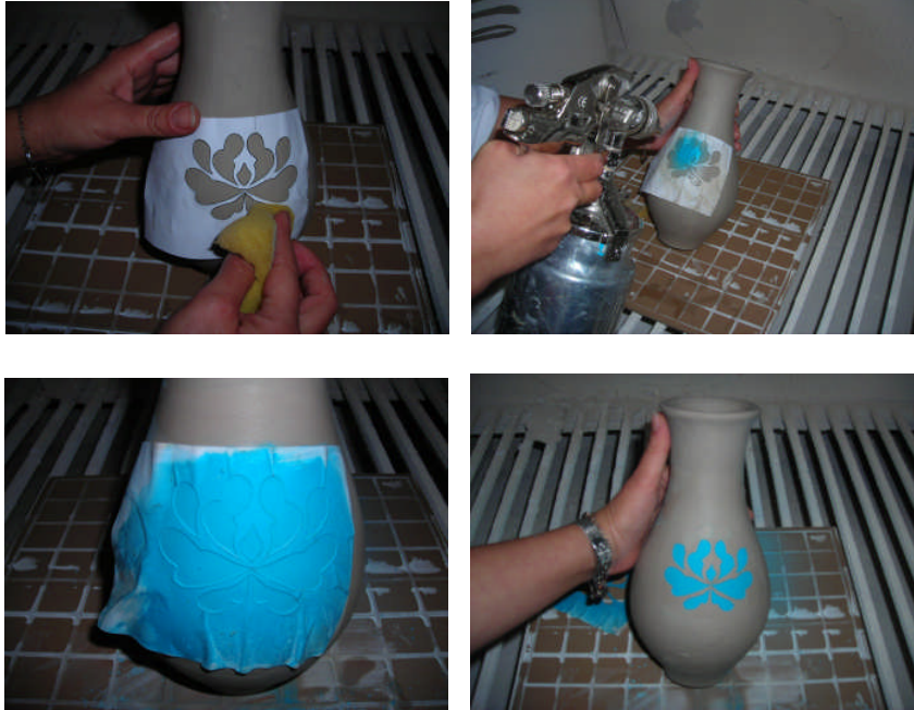
Resim 1. 1.a-b-c-d: Deri sertliğindeki çamur üzerine şablon dekoru uygulaması
