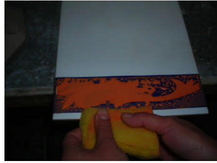
Resim 5. 1: Sır fazlalıklarının sünger ile silinmesi
