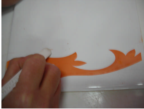
Resim 5. 2: Sır fazlalıklarının kazınması (rötuş)
