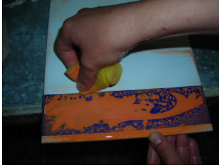
Resim 5. 1: Sır fazlalıklarının sünger ile silinmesi
