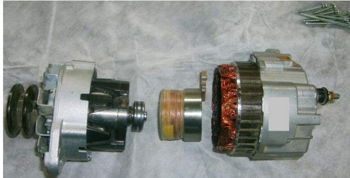
Resim 1.8: Fırçasız alternatörün sökülmüş hâli
