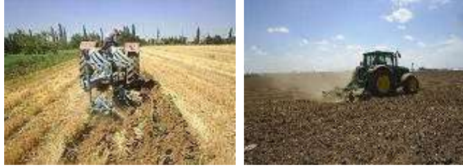
Resim 1.6: Anız bozumu ve derin sürüm Resim 1.7: Yüzeysel sürüm ve tohum yatağı hazırlama
