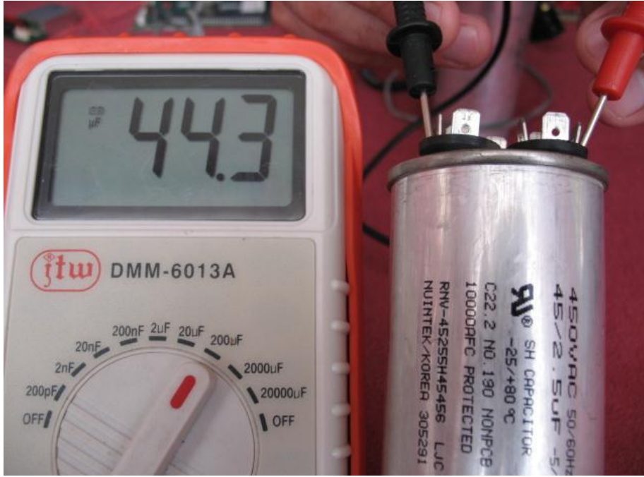
Resim 1.16: Kapasitemetre ile bir kapasitörün ölçülmesi ve etiket değeri ile karşılaştırılması
