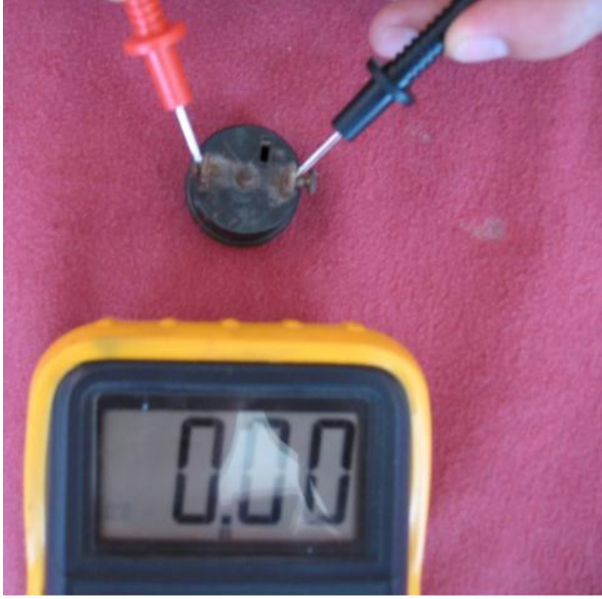
Resim 1.8: Avometre ile termiğin sađlamlık kontrolünün yapılması
