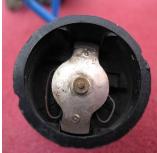
Resim 1.7: Termiğin bi-metalinin ve rezistans telinin görünümü
