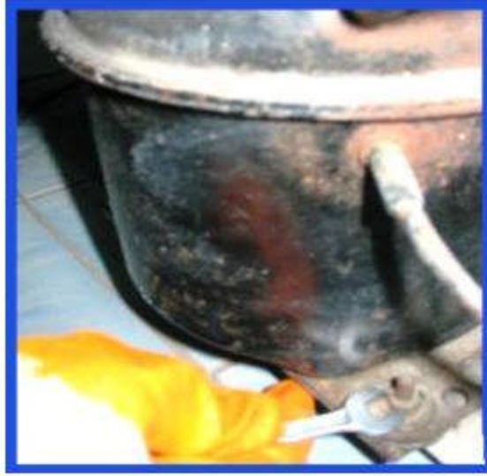
Resim 2.14: Kompresör bağlantı cıvatalarının sökülmesi
