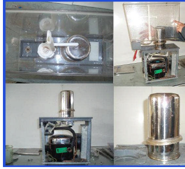
Resim 2.16: Şerbetlik hazneli evaporatör demontajı
