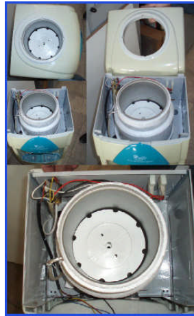
Resim 2.15: Sebil hazneli evaporatör demontajı
