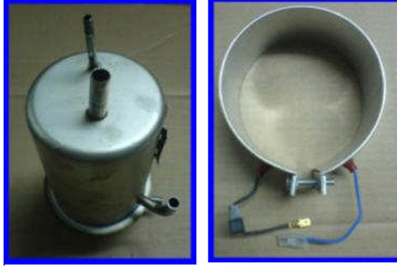
Resim 1.17: Su ısıtıcı haznesi demontaj/montajı
