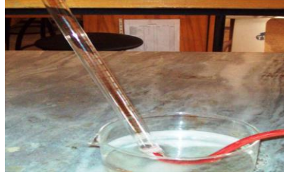
Resim 2.11: Gaz toplama borusu
