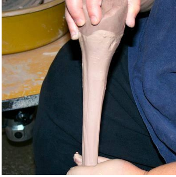
Resim 1.18: Çekme kulp için sucuğun yapılışı
