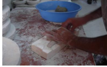
Resim 1.9: Kalıpta kulp yapımı
