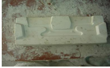
Resim 1.8: Kalıpta kulp yapımı
