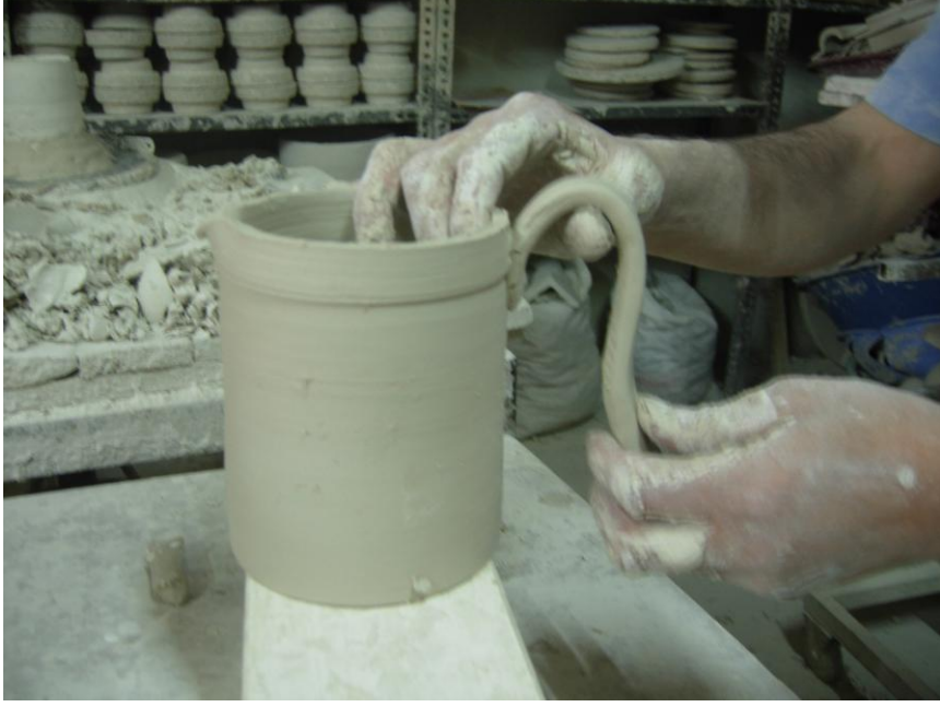
Resim 3.1: Kulpun üst kısmının yapıştırılması
