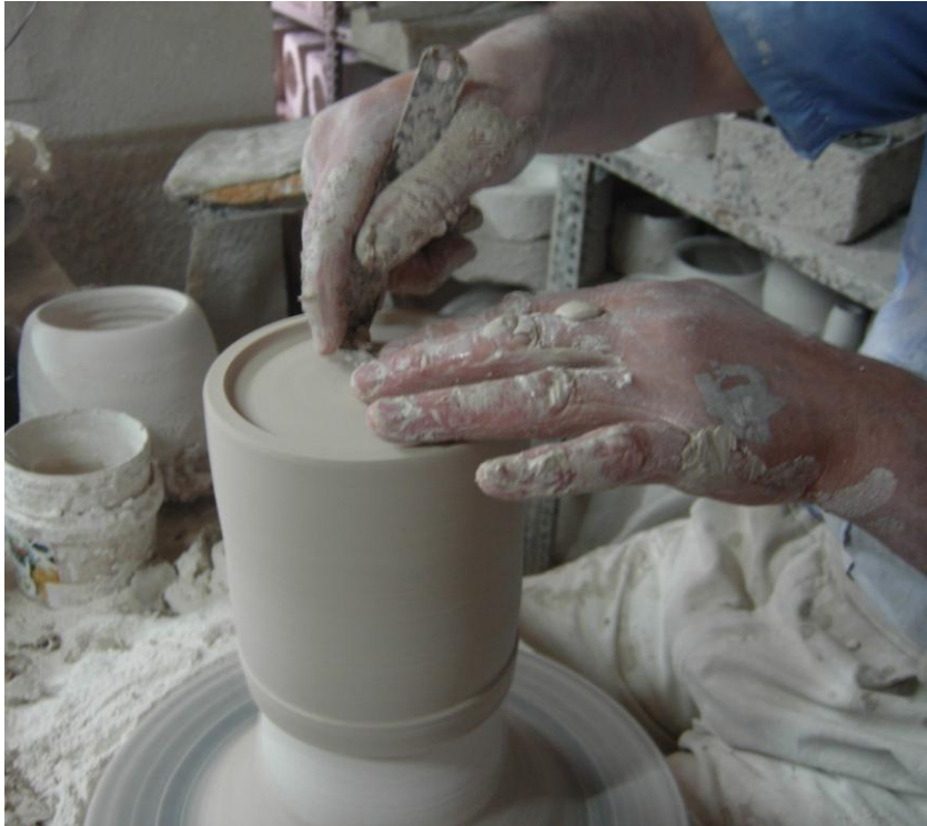
Resim 2.3: Dip alma rötuşlama işlemi
