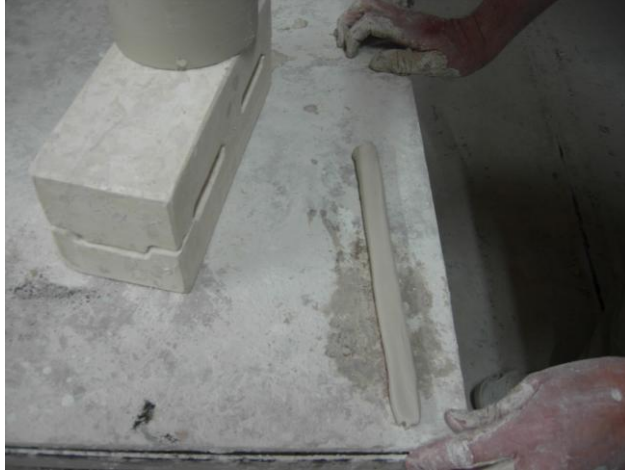
Resim 1.16: Kulp için sucuğun yapılışı
