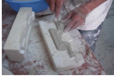
Resim 1.12: Kalıpta kulp yapımı
