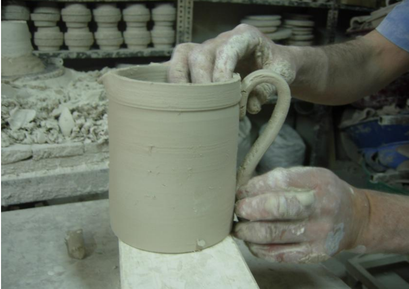
Resim 3.2: Kulpun alt kısmının yapıştırılması
