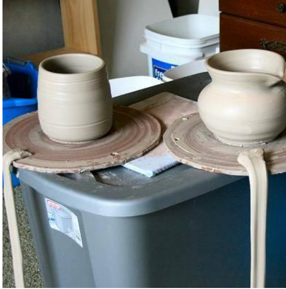
Resim 1.19: Çekme kulp için sucuğun yapılışı
