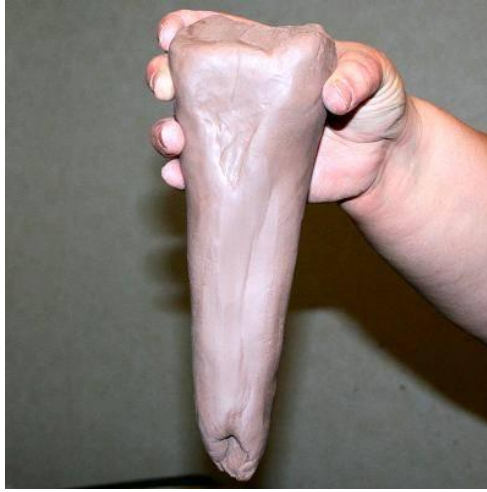
Resim 1.17: Çekme kulp için sucuğun yapılışı
