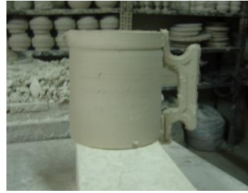
Resim 1.13: Kalıpta kulp yapımı
