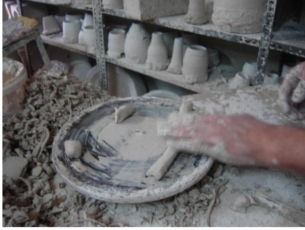
Resim 1.15: Kulp için sucuğun yapılışı
