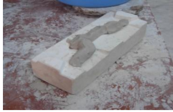
Resim 1.10: Kalıpta kulp yapımı
