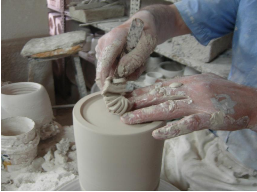
Resim 2.2: Dip alma, ayak çıkarma işlemi
