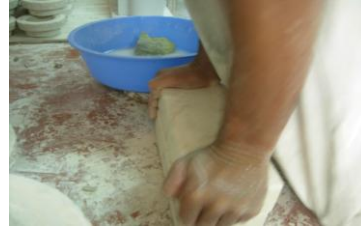
Resim 1.11: Kalıpta kulp yapımı
