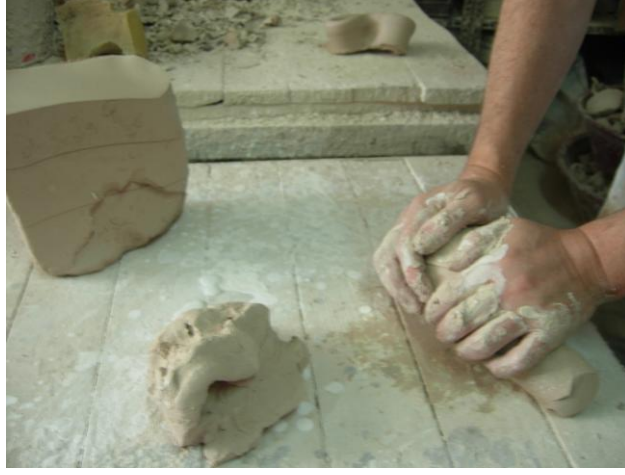
Resim 1.14: Kulp için çamurun yoğrulması
