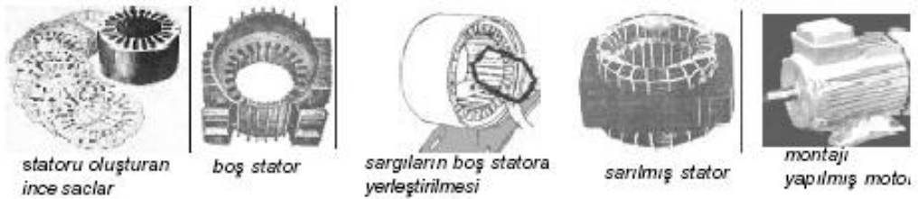
Şekil 1.21: DC-AC motorların gövde ve statorları
