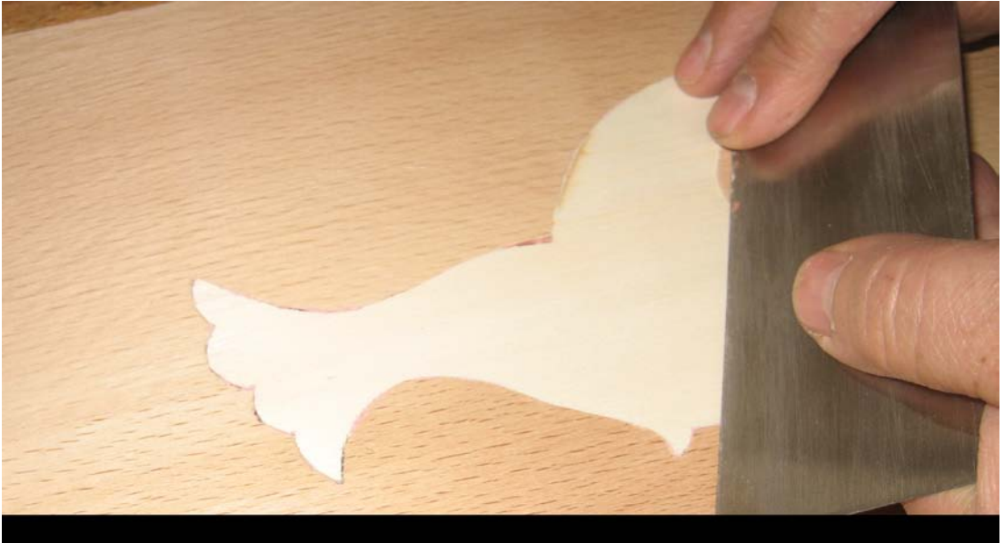
Resim 2.8: Kakma ve fon parçasının sistrelenmesi
