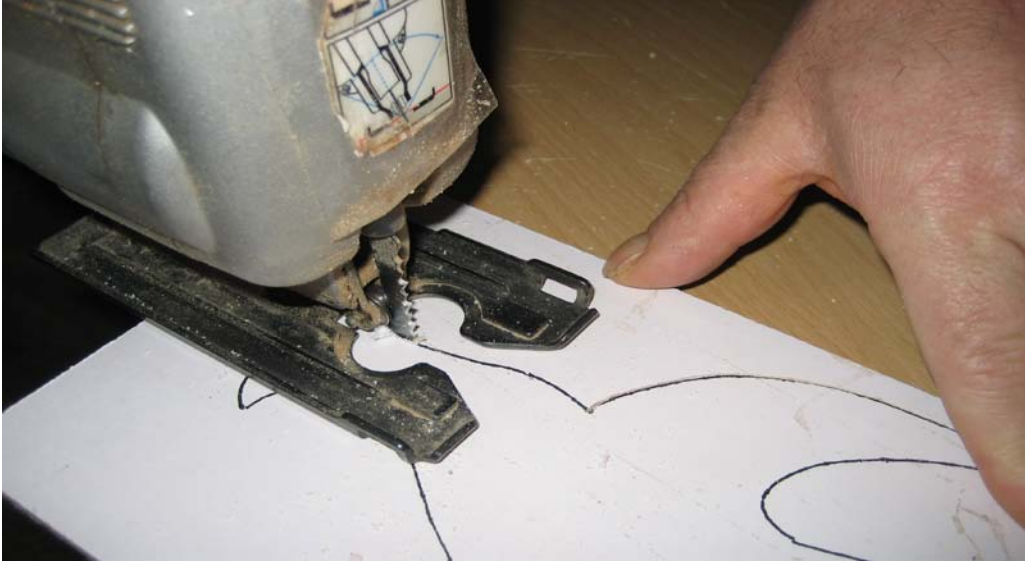
Resim 1.17: El deкупaj makinesiyle kesim yapma
