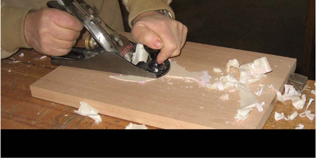
Resim 2.7: Kakma parçasındaki fazlalıkların rendelenmesi
