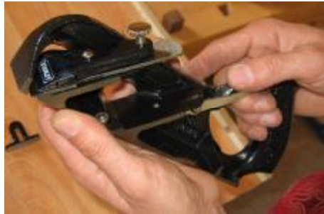
Resim 59: köşe düztabanına dönüştürülmüş normal düztaban
