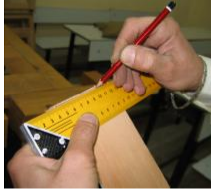
Resim 65: Gönye ile iş parçası boyunun markalanması
