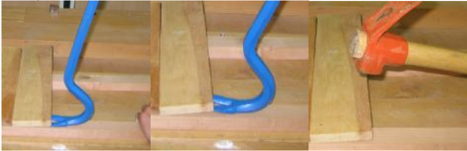
Resim 30: Tamamen çakılmış çivi başının iş parçası yüzeyine çıkarılması
