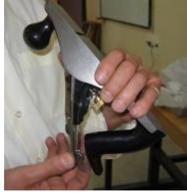
Resim -61.a,b; Rende tığı talaş kalınlığının ayarlanması
