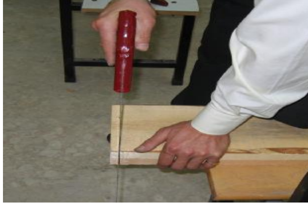
Resim 42: Pala testeresi Kesim açısı
