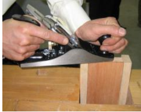
Resim -66.a,b: Demir rende ile maktanın, zıt yönlerde rendelenmesi.
