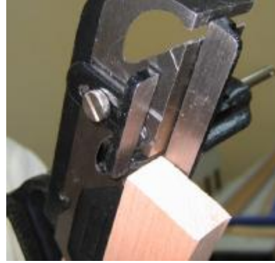
Resim 68: Demir düztaban ayarlandıktan sonra lamba açılmamış iş parçasının rende tabanına Yerleştirilmesi
