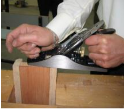
Resim -66.a,b: Demir rende ile maktanın, zıt yönlerde rendelenmesi.
