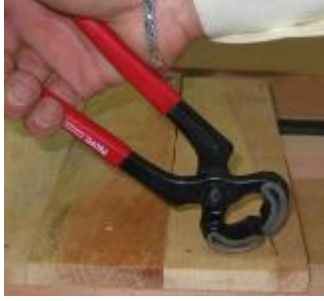
Resim 31: Kerpetenle tel çivinin sökülmesi
