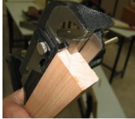
Resim 70: Demir düztabanla lamba açılmış iş parçası
