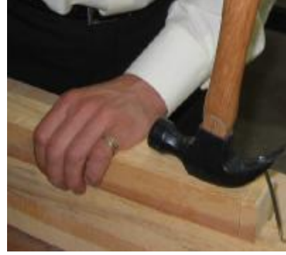
Resim -28.a,b,c,d: Çekiçle çivinin sökülme aşamaları
