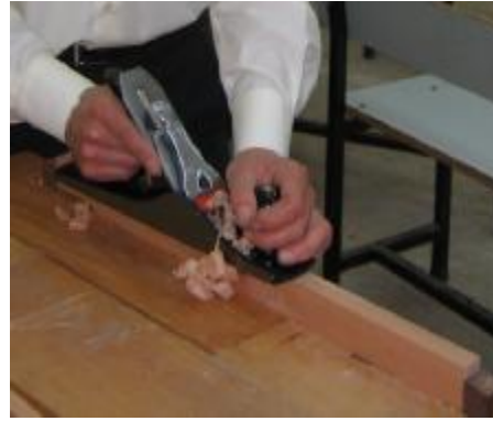
Resim -64.a,b; İş parçası cumbasını ahşap ve metal planya ile rendeleme
