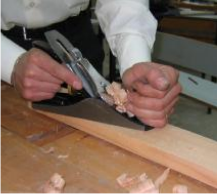
Resim -62; Demir rende ile yüz rendeleme
