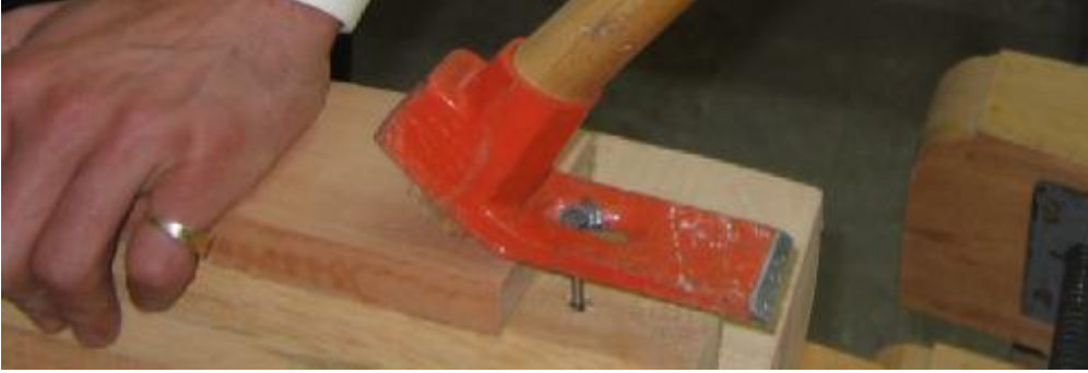
Resim 29: Çivinin keserle sökülmesi
