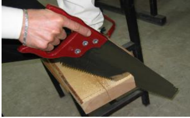
Resim 41: Pala testeresi kesim açısı
