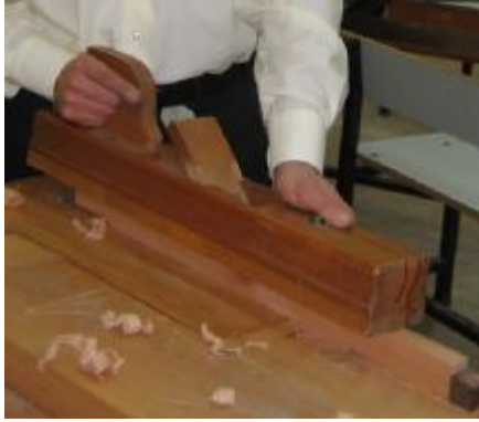
Resim -64.a,b; İş parçası cumbasını ahşap ve metal planya ile rendeleme
