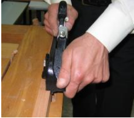
Resim 69: Demir düztabanla, iş parçasına lamba açılması.
