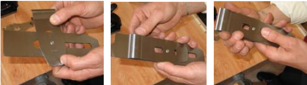
Resim 60:a,b,c- Rende tığ kapağının takılması
