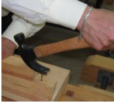
Resim -28.a,b,c,d: Çekiçle çivinin sökülme aşamaları
