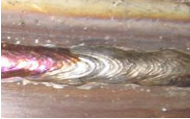
Resim 1.6: Kaynak dikişinin etrafındaki renk değiştirmiş bölge ve ısıdan etkilenmemiş bölgeler
