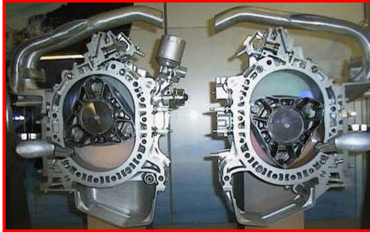
Resim 3.4: Wankel Motorunun Kesit Resmi
