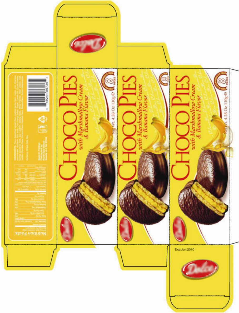
Resim 4.1: Taşma payları, kesim ve kırım çizgileri verilmiş ambalaj tasarımı
