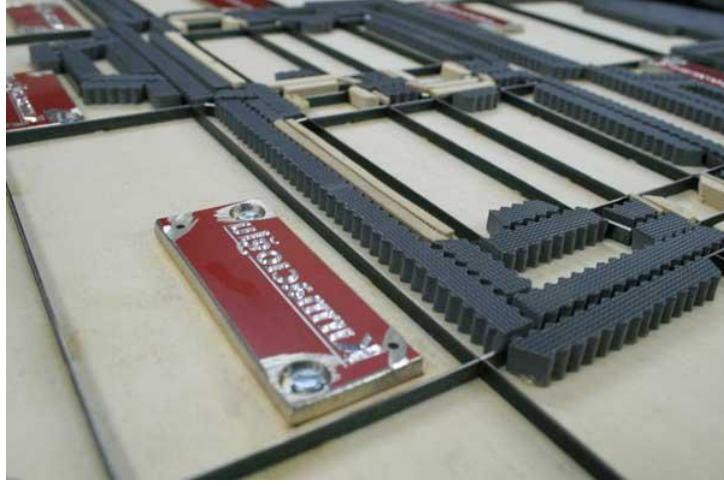
Fotoğraf3.1: Ambalaj kesiminde kullanılan özel bıçak
