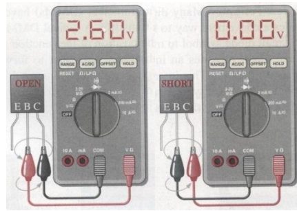
Resim 1.3: PNP tipi transistörde arıza tespiti
