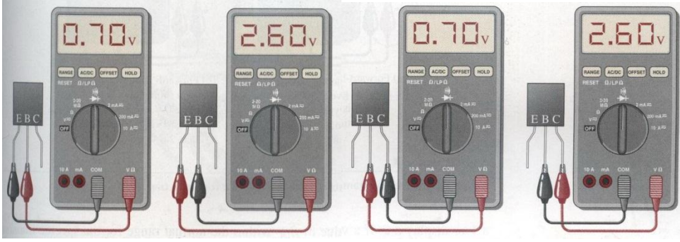
Resim 1.2: NPN tipi transistörde arıza tespiti
