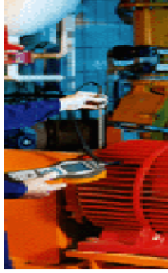
Resim1.5: Doğrudan ölçme yapan ve okunabilen titreşim ölçüm cihazı
