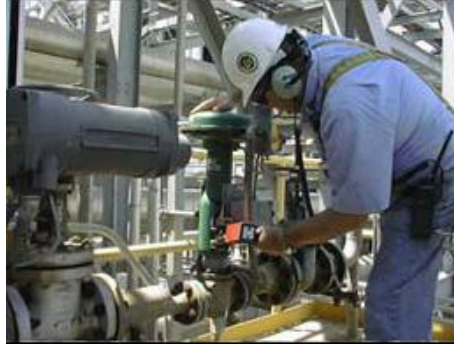
Resim 2.8: Ultra Sonik Testin yapılışı
