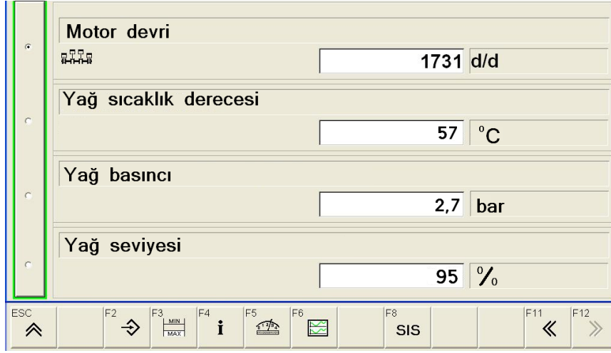
Resim 1.3: Diagnostik cihazında yağlama sistemi sensörleri gerçek değer bilgileri
