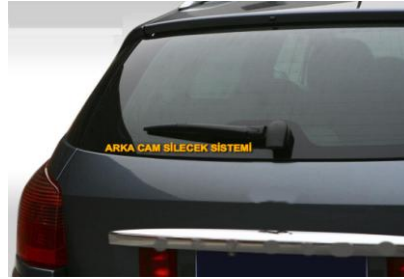
Resim 2.6: Arka cam silecek sistemi
