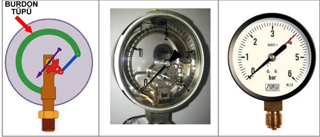
Şekil 1.4: Basınçlı (Burdon tüplü) tip yağ göstergesi
