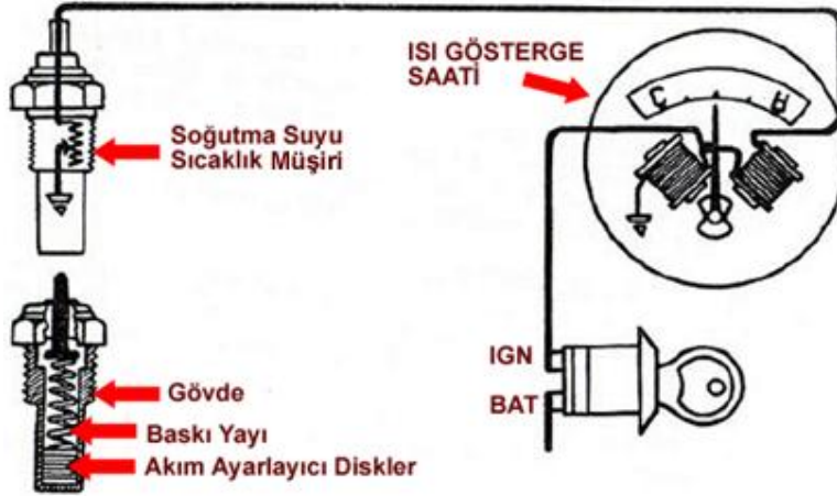
Şekil 1.15: Manyetik sıcaklık göstergesi devresi
