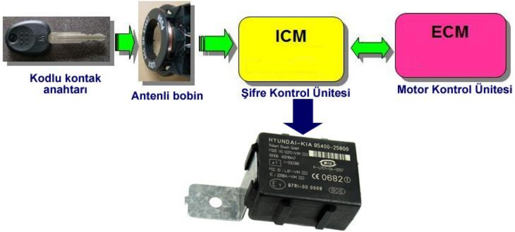
Resim 3.2: Şifre kontrol ünitesi
