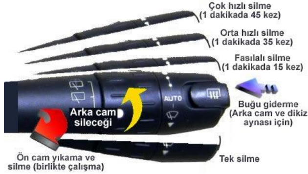
Resim 2.5: Cam silecek kumanda kolunun çalışması
