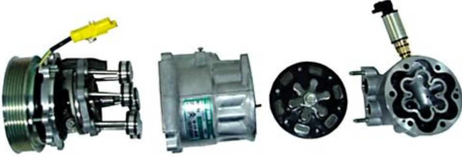
Resim 2.4: Değişken silindir hacimli kompresörün sökülmüş hâli
