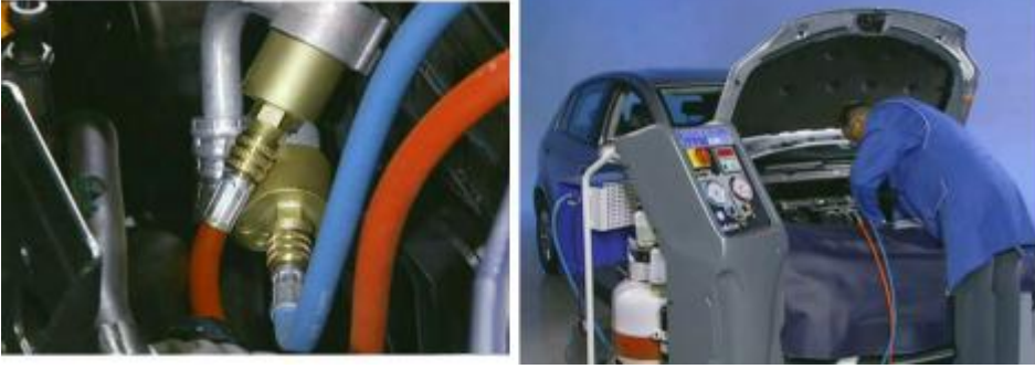
Resim 1.22: Klima temizliği için servis cihazının bağlanması
