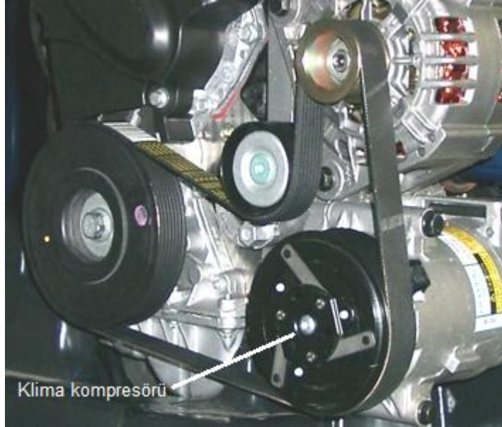
Resim 2.1: Klima kompresörünün araç üzerindeki yeri
