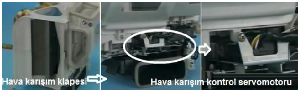
Resim 4.12:Hava karışım kontrol servomotoru
