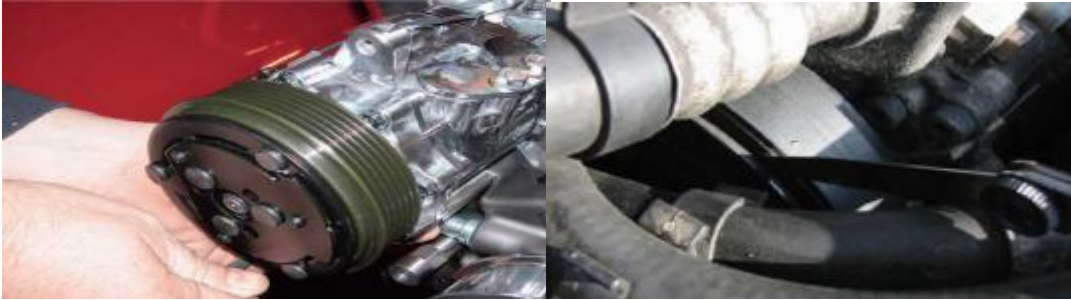
Resim2.11: Kompresör kavraması sıklığının sentille kontrolü
