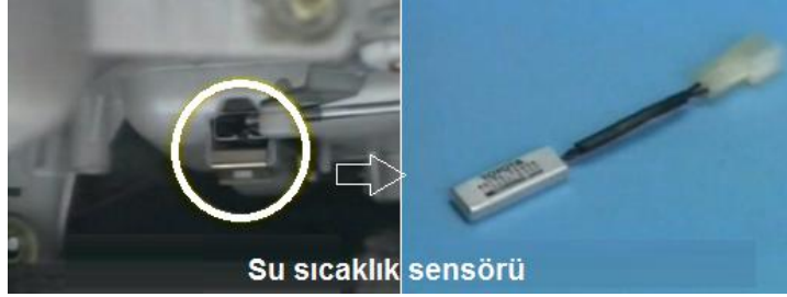
Resim 4.8: Su sıcaklık sensörü ve araç üzerindeki yeri
