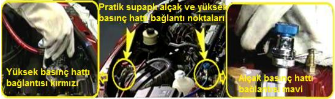
Resim 1.13: Klima sisteminin servis bağlantı noktaları (hızlı rekorlara bağlantı noktaları)
