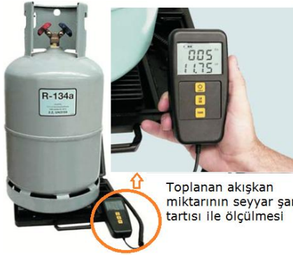
Toplanan akışkan miktarının klima test cihazı ekranından kontrol edilerek ölçülmesi
