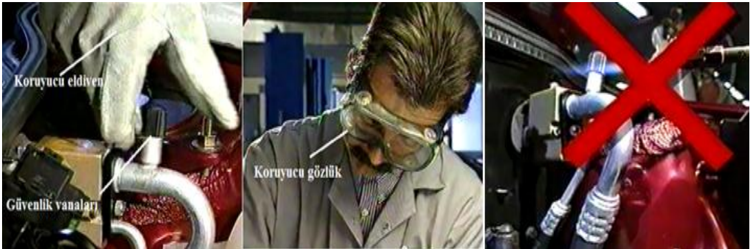
Resim 1.7: Klima sistemine müdahâlede alınacak güvenlik önlemleri
