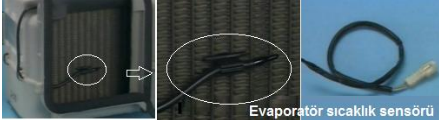
Resim 4.7:Evaporatör sıcaklık sensörü ve araç üzerindeki yeri
