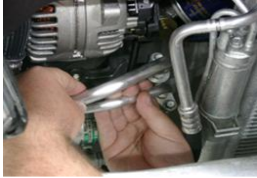
Resim 1.11: Dokunma yöntemi ile arıza tespiti
