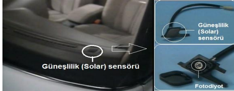
Resim 4.6:Güneşlilik (solar) sensörü ve araç üzerindeki yeri
