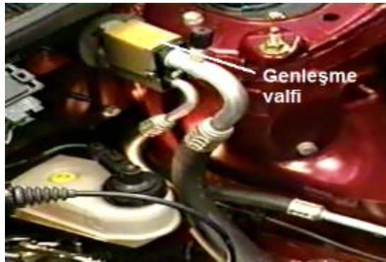
Resim 3.7: Genleşme valfi ve araç üzerindeki yeri
