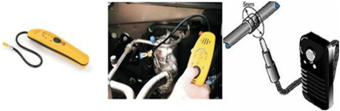
Resim 1.14: Elektrikli dedektörle klima sisteminde kaçak arama yöntemi
