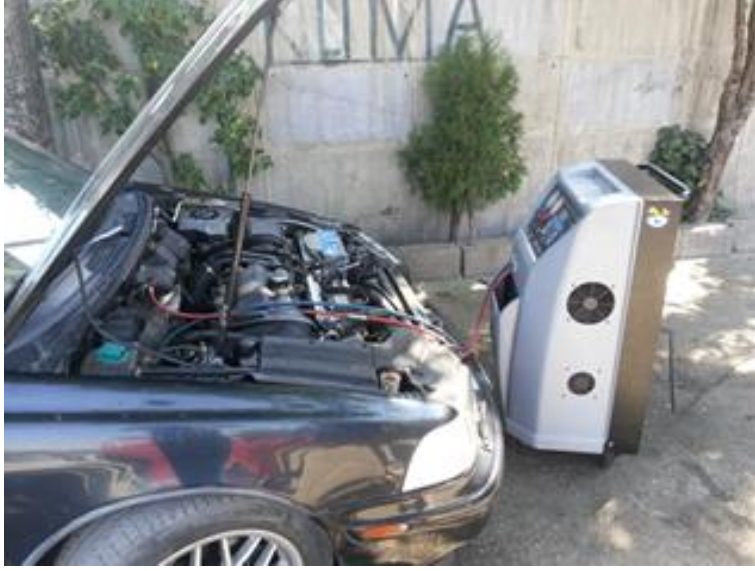
Resim 1.8: İstasyonun araca bağlanması
