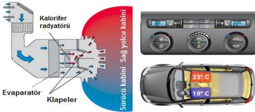
Resim 4.9: İki farklı bölgenin ayrı değerlerde soğutulması
