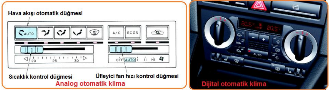
Şekil 4.2: Analog ve dijital klima kumanda panelleri
