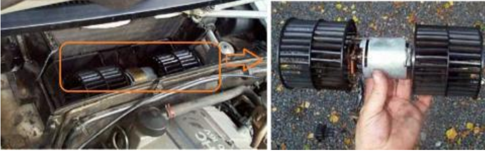
Resim 3.6: Evaporatör ve evaporatör elektrofani (blower)
