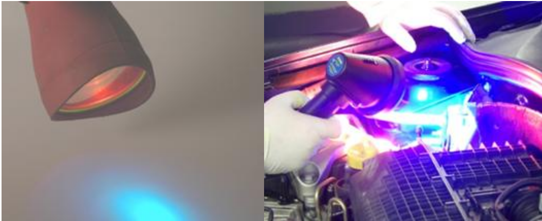
Resim 1.16: İz süren dedektör ve klima sisteminde kaçak arama yöntemi
