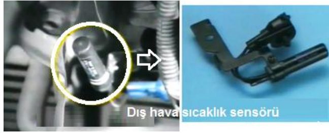
Resim 4.4: Dış hava sıcaklık sensörünün ve araç üzerindeki yeri
