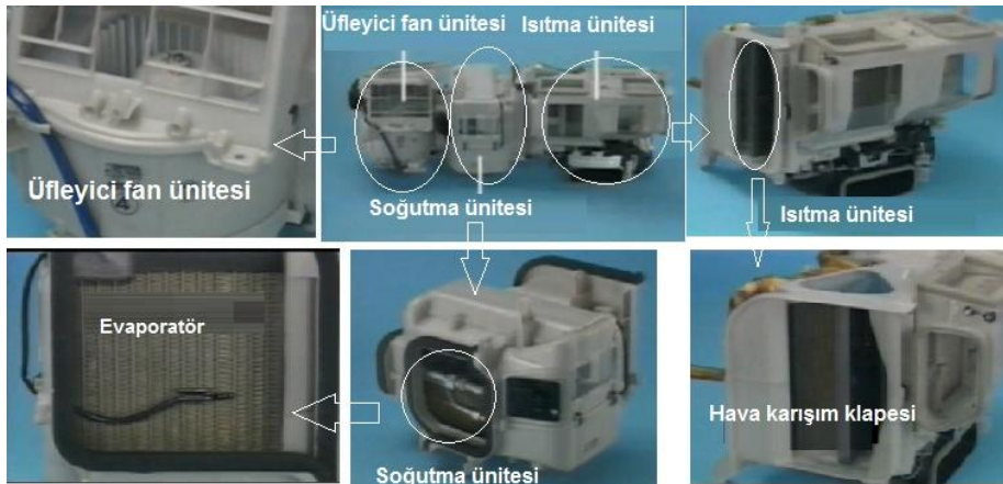
Resim 4.10: Otomatik klimalı araçta evaporatör kutusu ve içerisindeki üniteler
