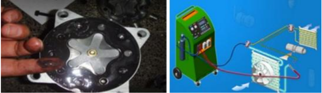
Resim 1.21: Klima sistemi soğutucu akışkan devresinin temizlenmesi
