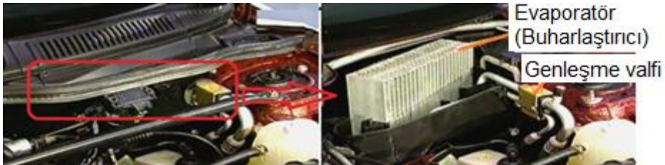
Resim 3.4: Evaporatör ve araç üzerindeki yeri
