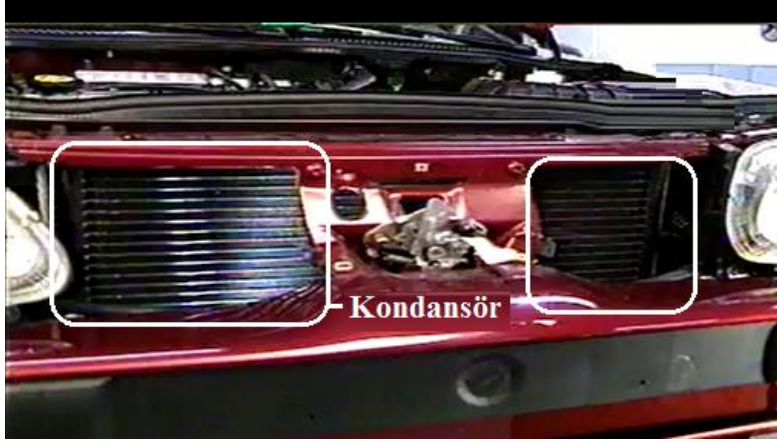
Resim 3.1: Kondansörün araç üzerindeki yeri
