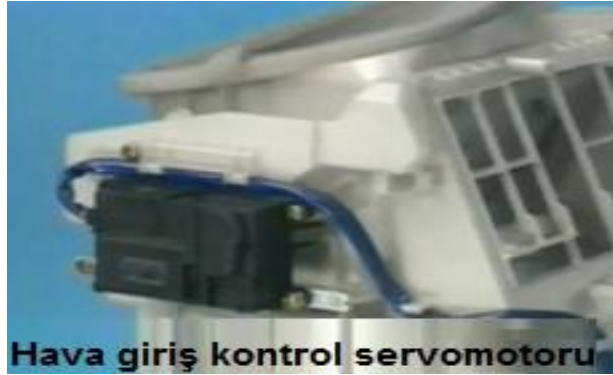
Resim 4.11:Hava giriş kontrol servomotoru
