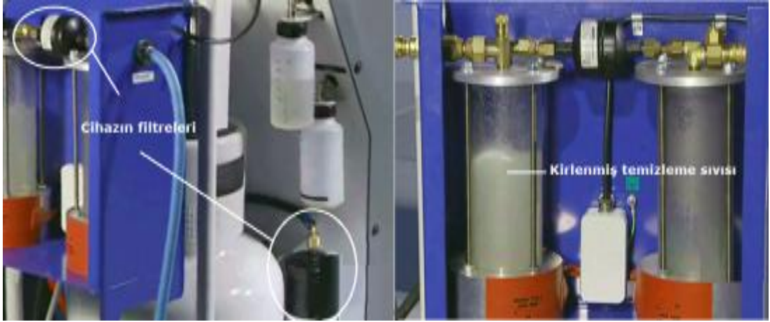
Resim 1.23: Klima servis cihazı filtreleri ve temizleme işlemi
