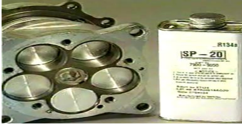
Resim.2.7: Kompresör ve yağı
