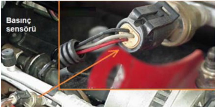
Resim 3.11: Yüksek basınç hattında kullanılan basınç sensörü
