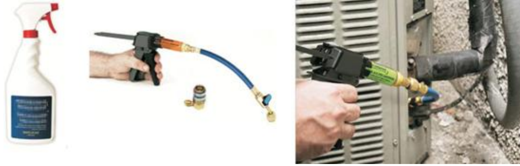
Resim 1.15: Sisteme boyar madde (renklendirici) konulması
