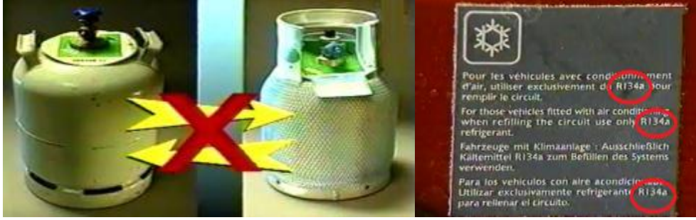
Resim 1.2: Araç üzerinde klima sisteminde hangi gaz kullanılmış olduğuna dair bilgi
