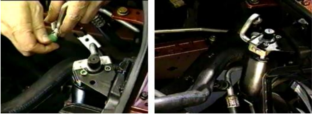
Resim 3.24: Nem tutucu filtrenin değişimi
