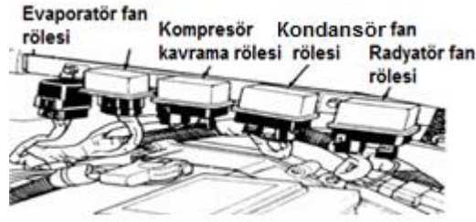
Şekil 3.7: Klima sistemi elektrik röleleri
