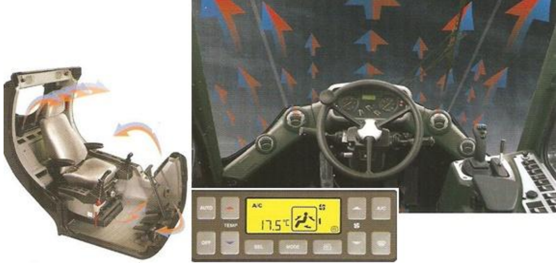
Şekil 4.10: İş makinelerinde kullanılan otomatik klima sisteminin işlevi
