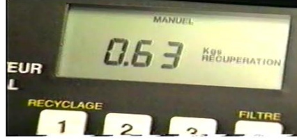
Toplanan akışkan miktarının klima test cihazı ekranından kontrol edilerek ölçülmesi
