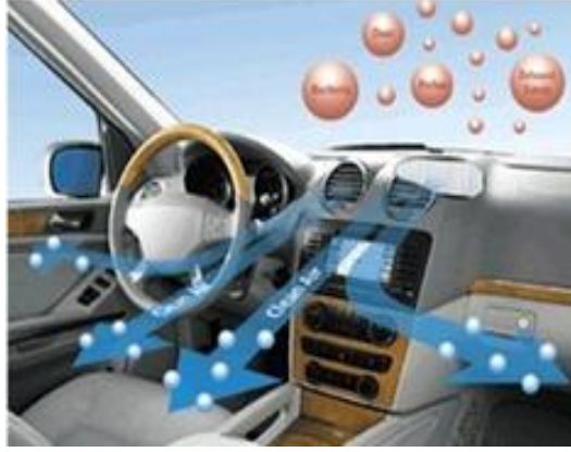
Şekil 1.5: Klima sisteminde partikül filtrelerinin fonksiyonu
