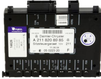
Resim 6.4: Elektrikli koltuk modülü (beyin)
