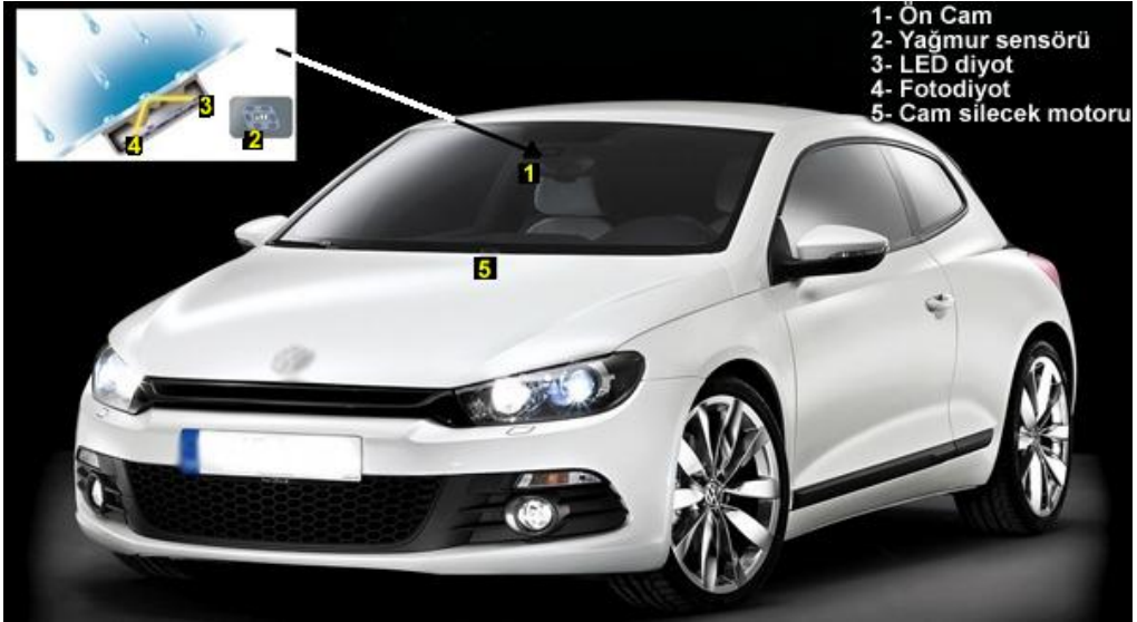
Resim 8.1: Yağmur sensörünün araç üzerindeki yeri
