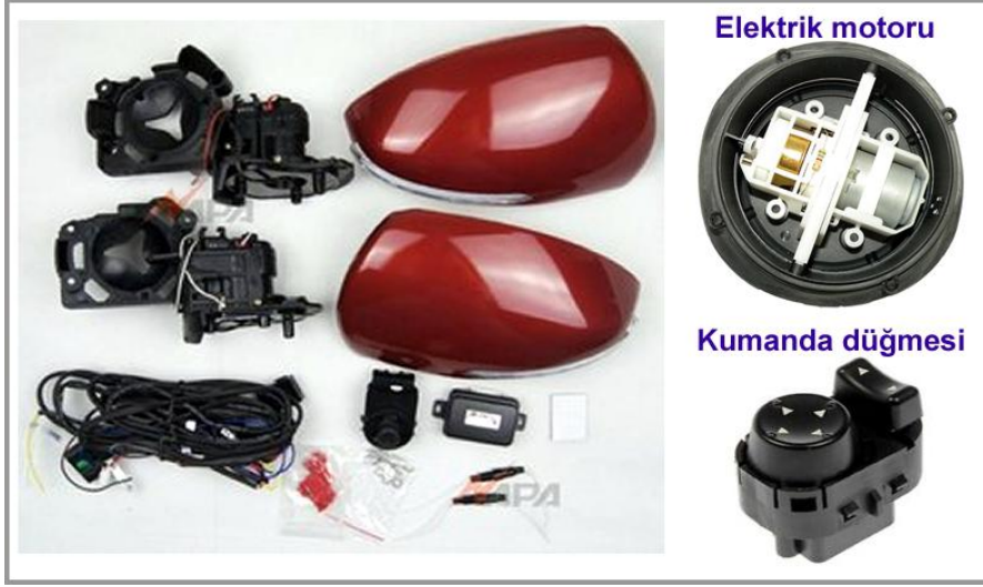
Resim 3.3: Elektrikli aynaların temel parçaları
