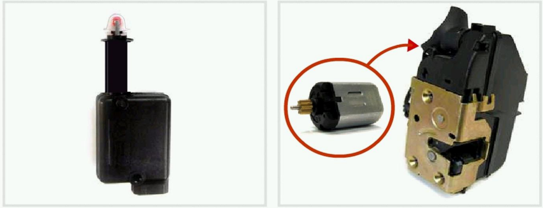
Resim 1.1: İki farklı kilit motoru (aktüatörler)
