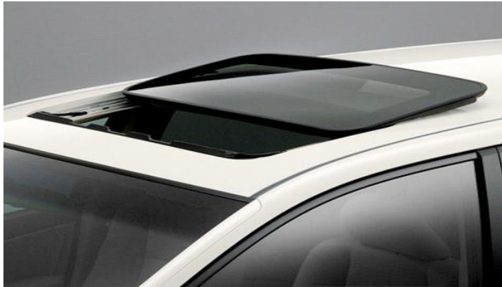
Resim 5.1: Sunroof (açılır kapanır tavan sistemi)
