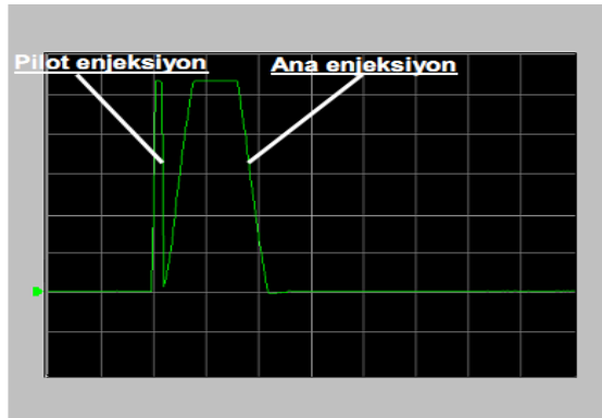
Şekil 2.13: Piezo aktivatör diagnostik görüntüsü
