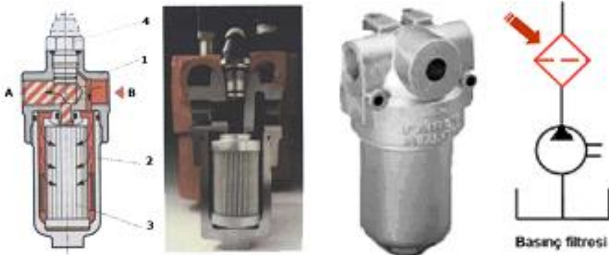
Şekil 2.6: Basın filtresi, alıřma prensibi ve sembolü
