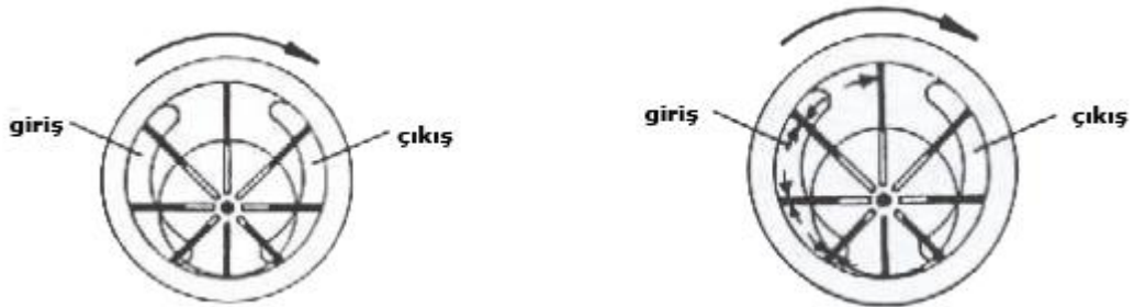
Şekil 4.11: Paletli motor ve paletli motoru döndüren kuvvet
